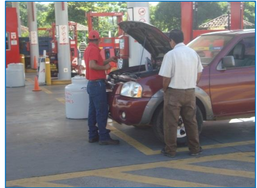
Ilustración 2.92. Actividad Revisión de niveles de agua y aceite.
