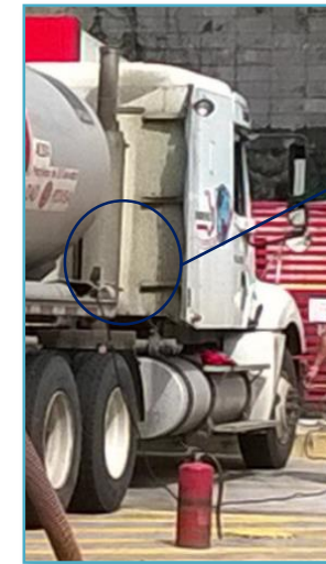
Ilustración 2.30. Conexión polo tierra Camión Cisterna.
