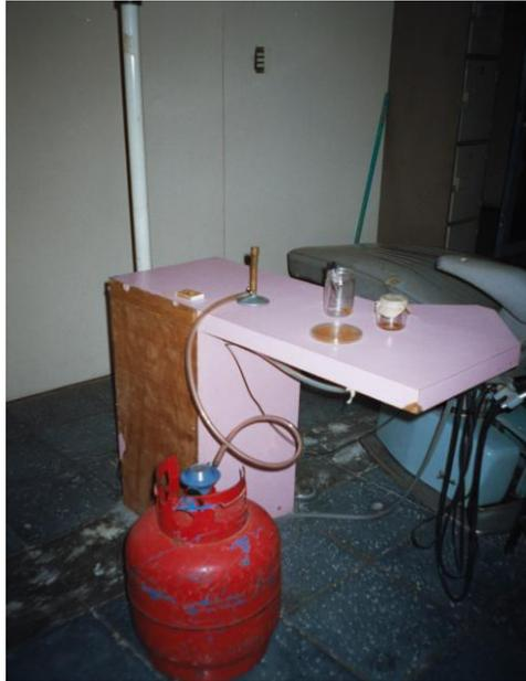
Preparación de módulo con mechero, tanque de gas, y medios para la toma de muestra microbiológica
