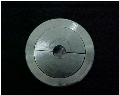
Figura 6 Matrices Metálicas, véase el anillo que abraza ambas partes de la matriz.
