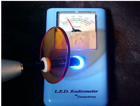
Figura 9. Monitoreo de la Intensidad de luz de los aparatos fotopolimerizadores.
