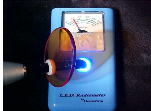
Monitoreo de las Lámparas de luz durante la confección de los cuerpos de prueba
