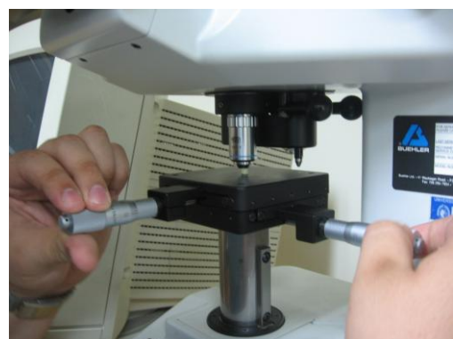
Ajuste de la mesa para identificar las posibles zonas para la indentación
