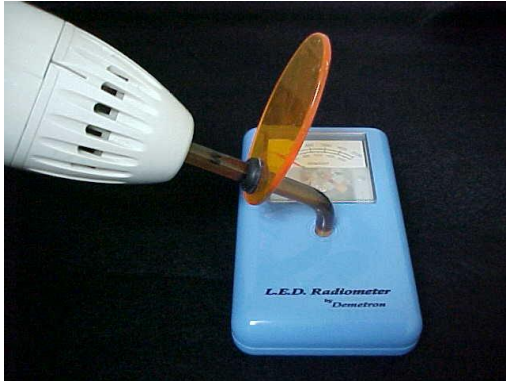
Monitoreo de las Lámparas de luz previo a la confección de los cuerpos de prueba
