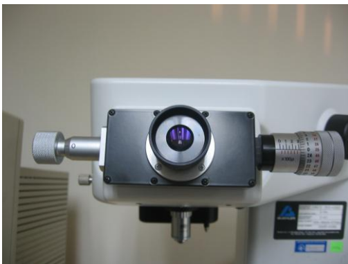
Lente, y brazos para registrar las mediciones de la indentación
