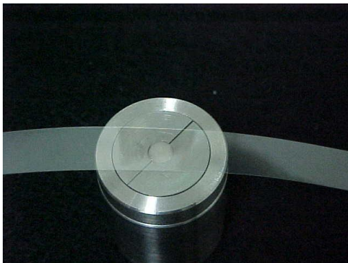
Colocación de Banda de Celuloide sobre la resina
