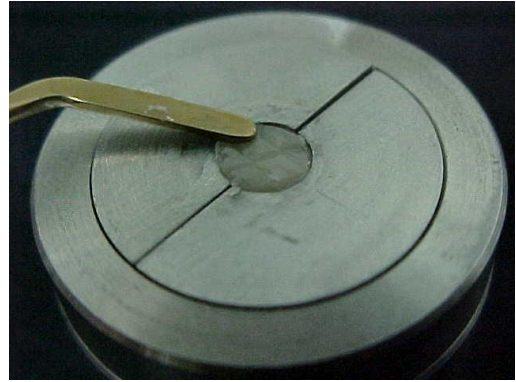
Condensado dentro de la Matriz Metálica con un instrumento de Resina
