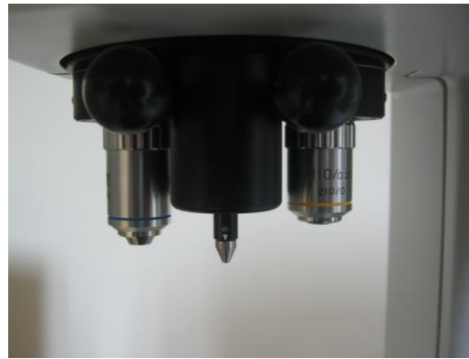
Microdurometro Micromet® 2001 (Buehler) Objeto Microscópico y punta de diamante
