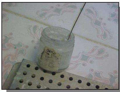
***Figura 17:*** Se ilustra la pasta fundente y un alambre de ortodoncia con el que se aplicará la soldadura. Cortesía del Dr. Douglas Escobar . (2004)
