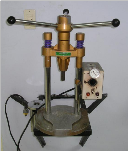
Fig. 54 Máquina inyectora para sistema VALPLAST®
