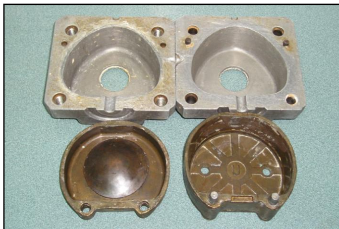
Fig. 51 Muflas para Prótesis Flexibles Sistema VALPLAST®.
