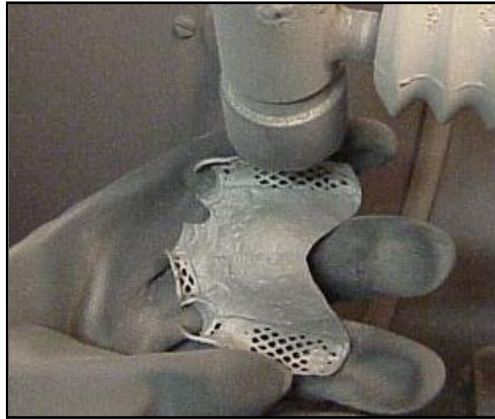
Fig. 36 Momento en que se somete una PPR a un arenado, para lograr una superficie mas lisa
