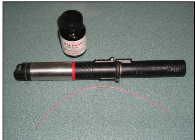
Fig. 55 Pistón neumático para la inyección del nylon.
