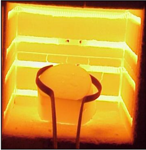
Fig. 32 Vista del bloque de revestimiento dentro del horno una vez a alcanzado la temperatura indicada. (1350 a 1400 C°).
