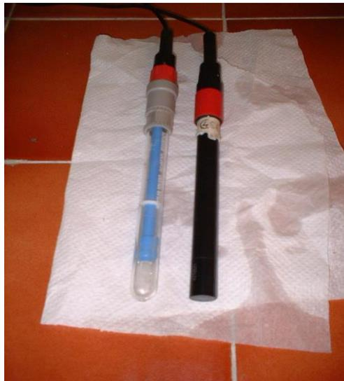
**Figura 7.** Electrodo de ion fluoruro (negro) y electrodo de referencia (celeste).
