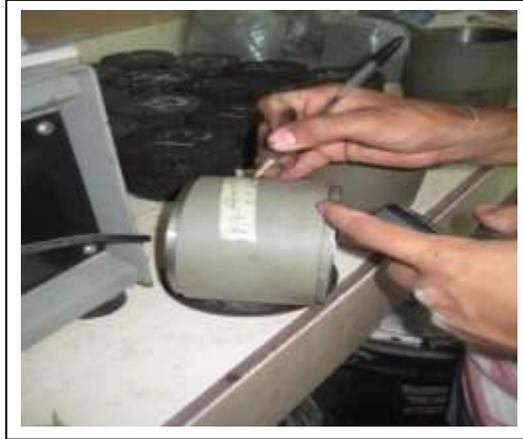
**FIG 3.17 Rotulación y curado de briquetas**
