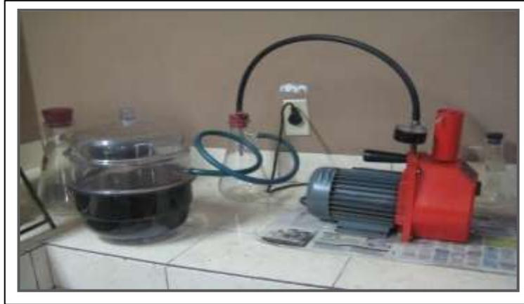
FIG 3.19 Sistema de inmersión y vacío parcial
