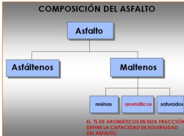
**FIG. 2.4 Composición química del ASFALTO.**
