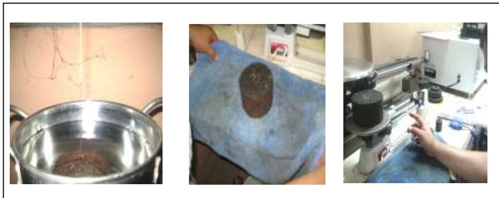
**FIG 3.18 Obtención de densidades para cada briqueta.**
