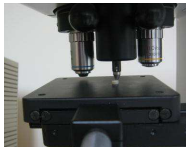
Proceso de indentación en los cuerpos de prueba, carga 200kgf/15 seg.
