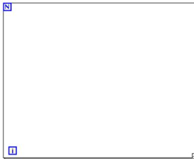
*Figura 2-15. Estructura For Loop*
