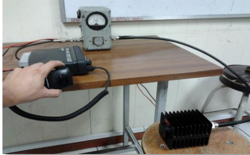
Figura 14. Medición de potencia de transmisión del Motorola PRO3100.
