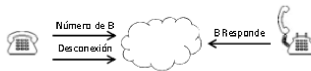
Figura 20. Intercambio de información de control de línea.
