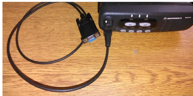
Figura 37. Conexión de cable de configuración.
