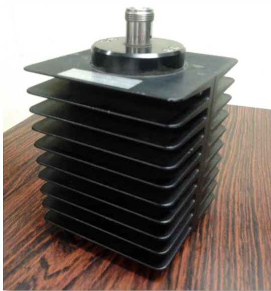
Figura 18. Dummy load o carga fantasma de 50\Omega y 150W.
