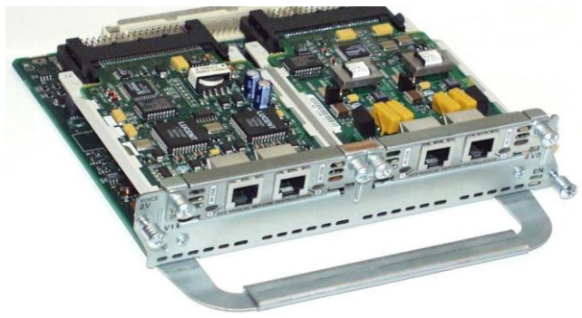
Figura 29. Módulo de red para router Cisco serie 2600.
