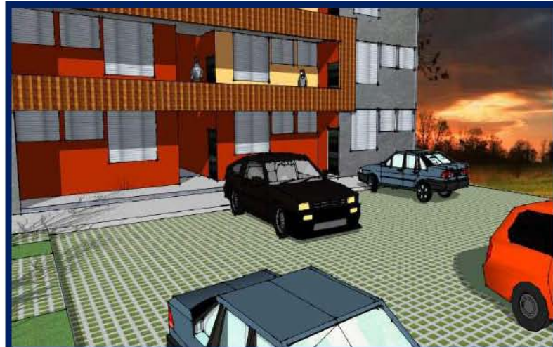
Fig. 216. área de aparcamiento integrada a cada grupo de apartamentos con superficie permeable
