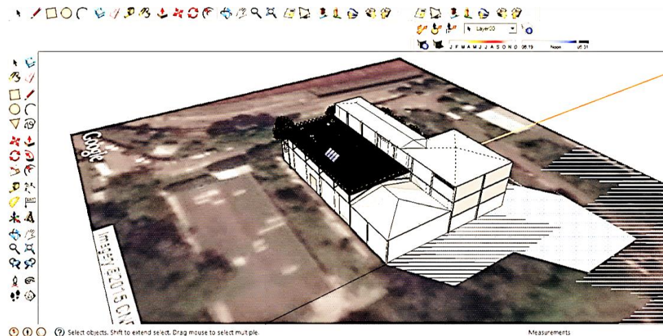
Fig. 2.40. Representación de la sombra proyectada por edificio a las 17:00 horas del solsticio de Inverno.
