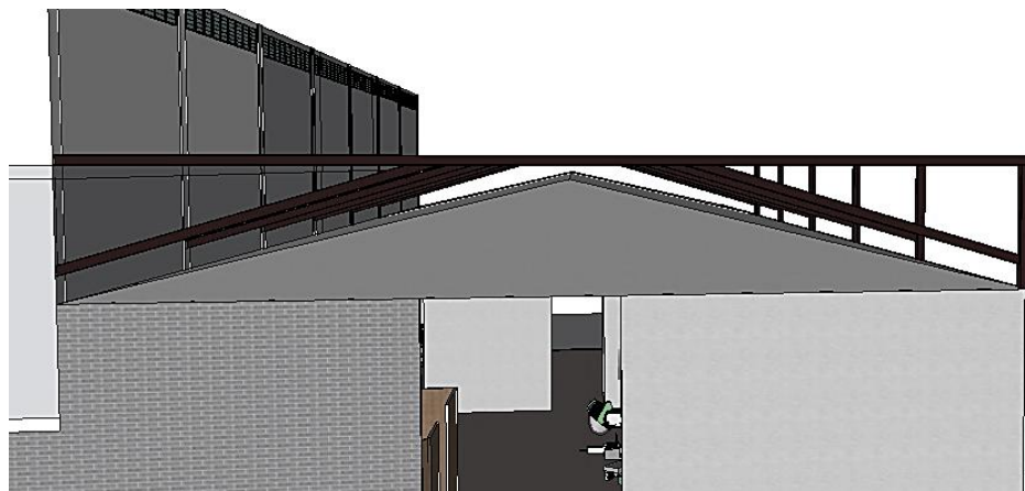
Fig. 2.26. Estructura de perfiles H vista frontal.
