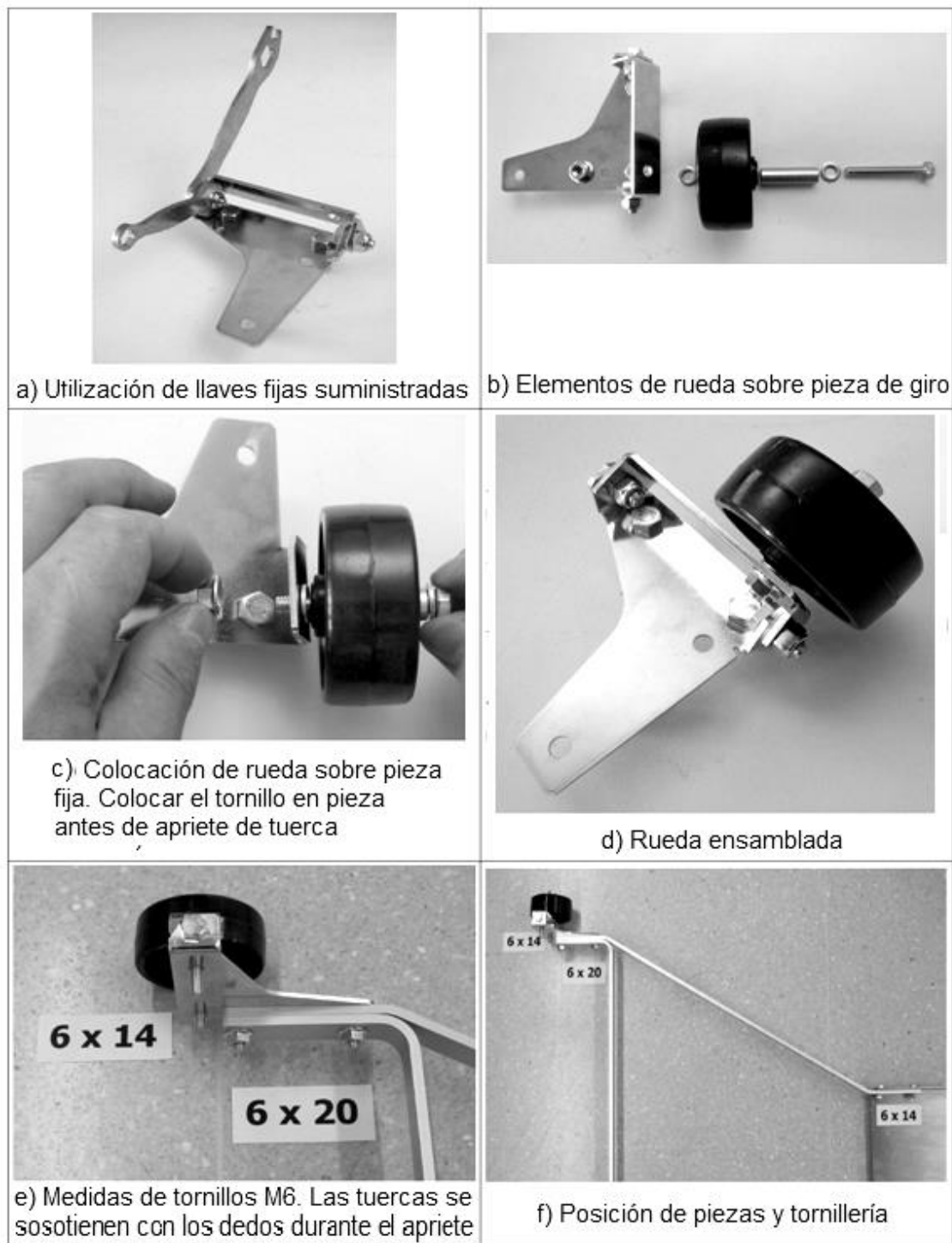
Fig. A-4.2. Forma de montaje de las ruedas del soporte de la cocina solar térmica alSol 1.2.
