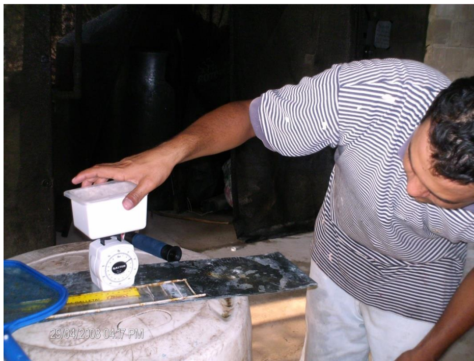
Anexo 11. Medición del peso las muestras por medio de la balanza analoga con capacidad de 260g y precisión de 0.01g.
