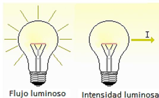
Ilustración 10. Diferencia entre Flujo luminoso e Intensidad Luminosa.
