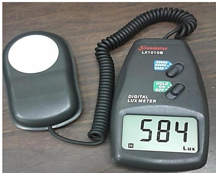
Ilustración 3: Medición obtenida del luxómetro adquirido para el desarrollo de la tesis.
