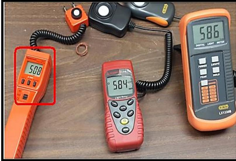
Ilustración 2: Comparación de mediciones con equipos calibrados.
