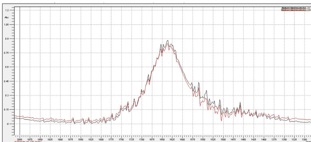
**Figura N°21: Espectros acoplados, Estándar de Acrilamida y Muestra de papas Lays clásica. Región B: 2000 – 1300  $\text{cm}^{-1}$ .**
