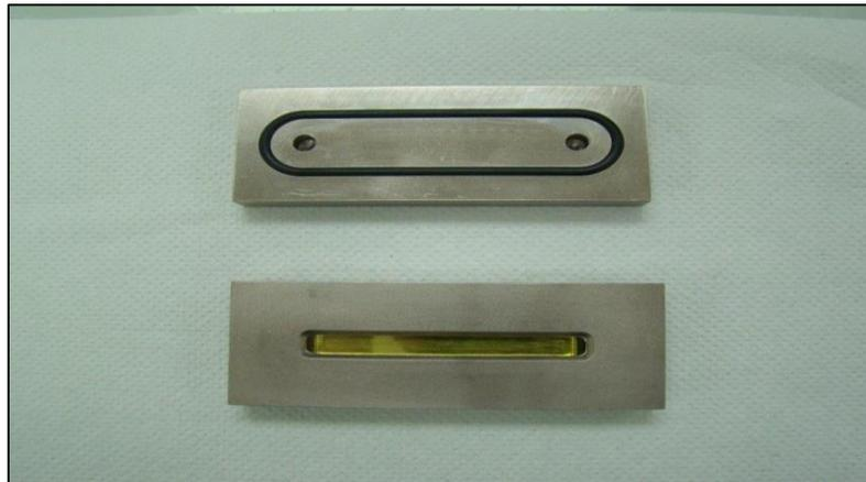
**FIGURA N° 25. CELDA DE REFLECTANCIA TOTAL
