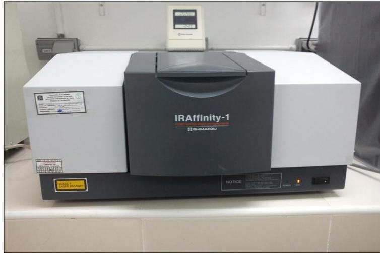
**FIGURA N° 24. ESPECTROFOTOMETRO INFRARROJO
