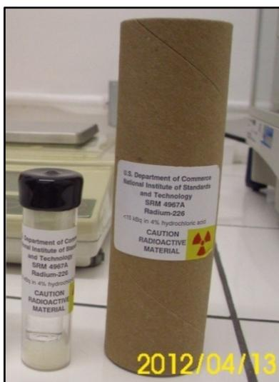
**Figura 41.** Patrón de referencia NIST de radio ( $^{226}\text{Ra}$ ). Cortesía CICANUM-UCR.
