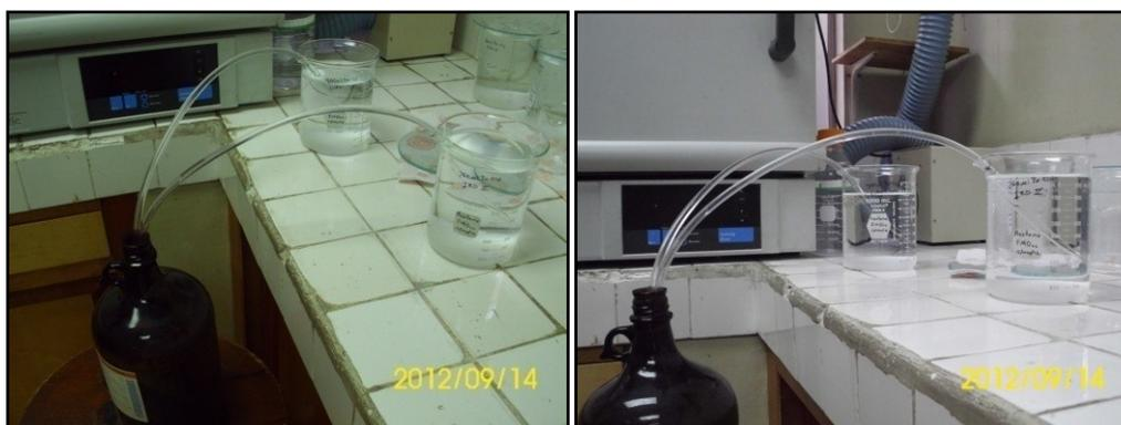
**Figura 86.** Sistema de succión utilizado en la decantación.
