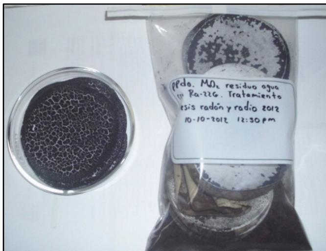
**Figura 90.** Precipitación de  $\text{MnO}_2$  para la recuperación de  $^{226}\text{Ra}$ .
