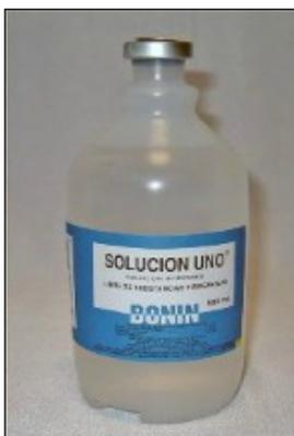
**Figura 91.** Frasco de 1 litro utilizado para el muestreo de radón en agua.
