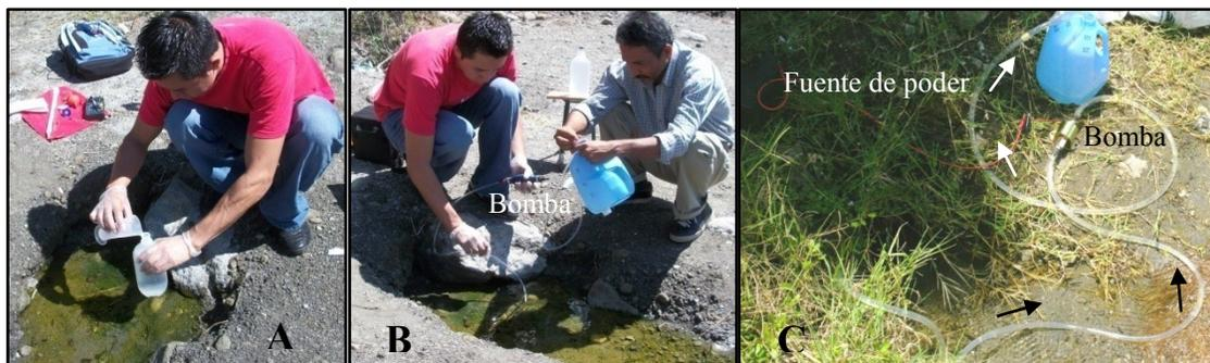
**Figura 68.** Diferentes métodos de recolección de la muestra.
