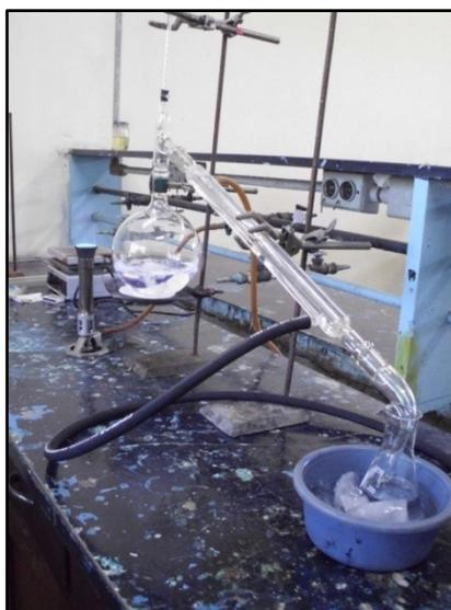
**Figura 84.** Destilación simple de coctel centellador usado.
