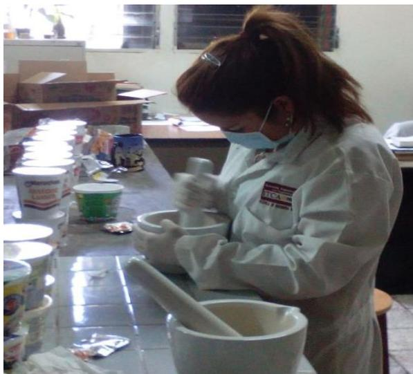
Figura N° 27 Preparación de las muestras triturandolas con mortero y pistilo
