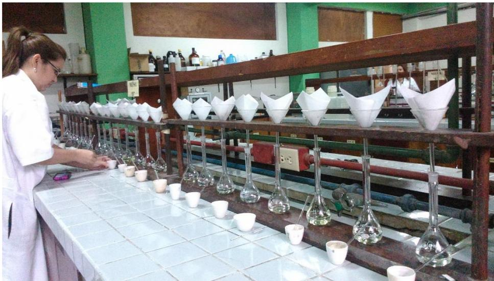
Figura N°31 Proceso de filtración de muestras.
