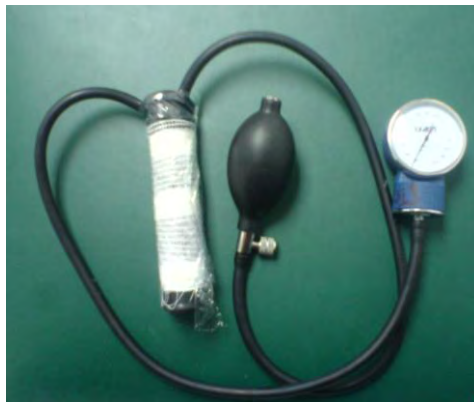
Transductor de presión bucal (tensiómetro modificado).
