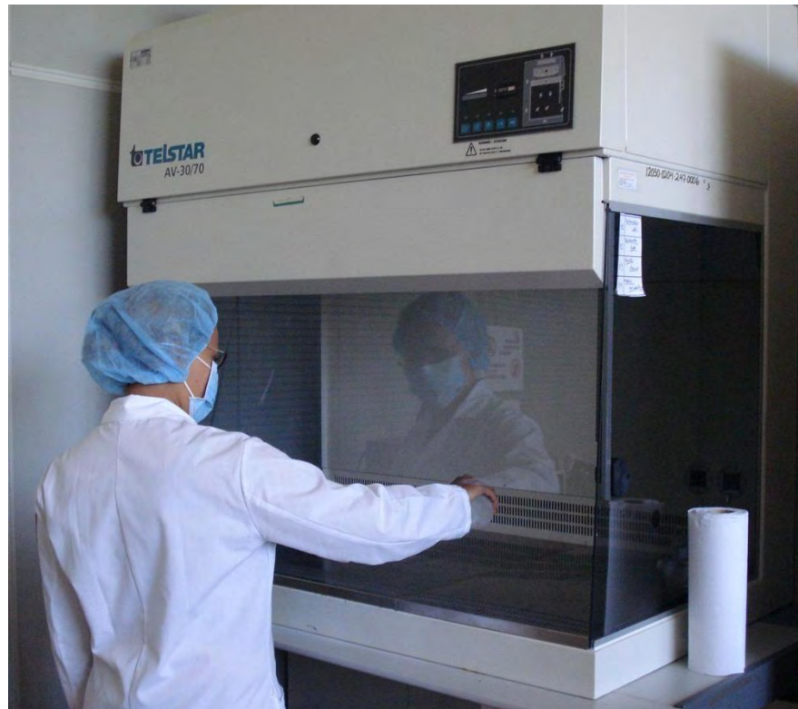
Fig. 4-3 Preparación de la cámara de flujo laminar
