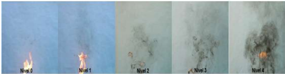
Figura 3.2: Escala de calificación del humo para cada prueba.
