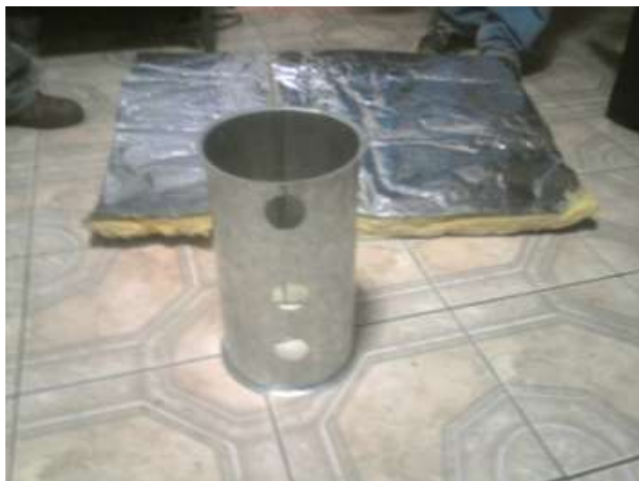
Figura F.3: Cilindro interno, donde se colocan los depósitos biomásicos
