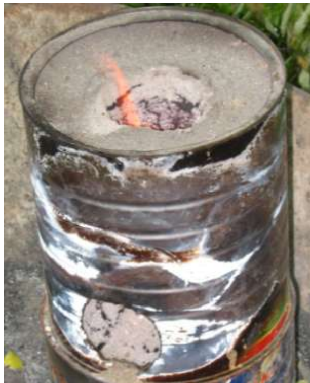
Figura D.4.: Combustion del aserrín compactado
