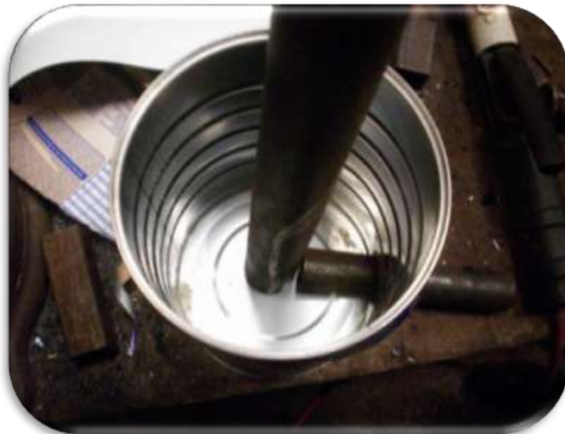
Figura 1.6: Introducción de los cilindros al recipiente del contenedor de biomasa (de arriba hacia abajo).
