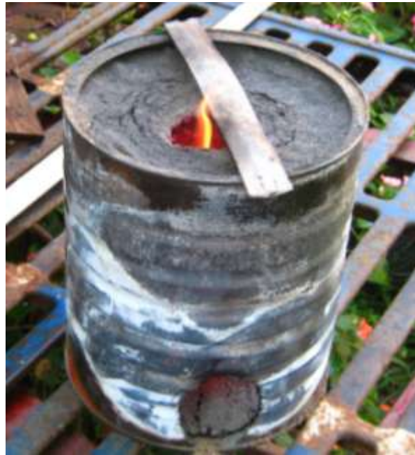
Figura D.5: Platina sobre la flama, para medir el hollín.
