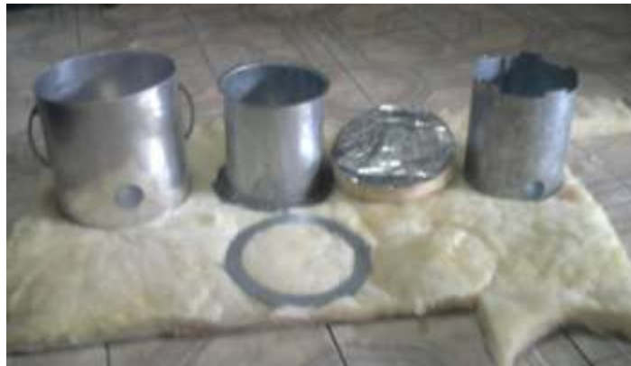
Figura G.2: De izquierda a derecha: cilindro externo, cilindro interno, arandela de ensamble, aislante de fibra fondo y depósito contenedor biomásico. Colocados sobre una tira de fibra de vidrio.
