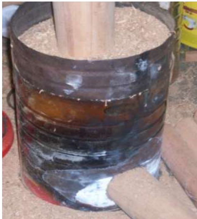
Figura D.6: Aserrin compactado dentro del depósito
