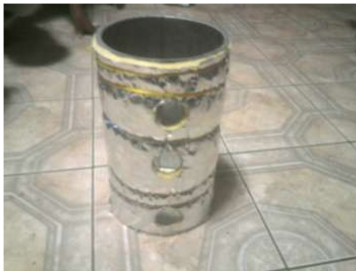
Figura F.4: Fibra aislante envuelto en el cilindro interno
