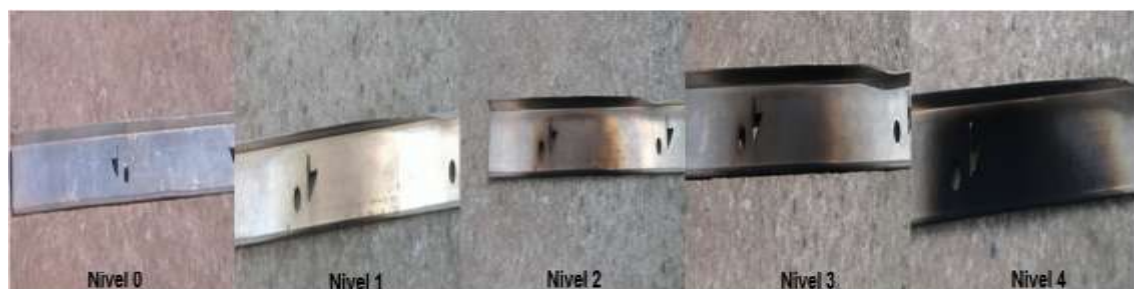
Figura 3.1: Escala de calificación del hollín para cada prueba
