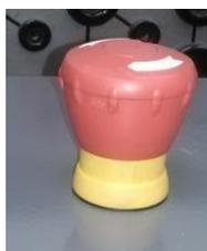
*Imagen 5.34 Paro de emergencia del módulo de prueba.*
