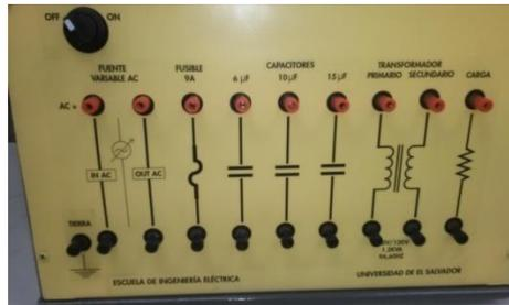
*Imagen 5.37 Borneras de conexión del módulo de prueba.*
