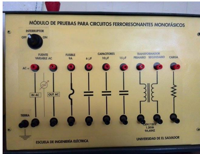
*Imagen 5.30 Muestra de módulo de prueba ya finalizado.*
