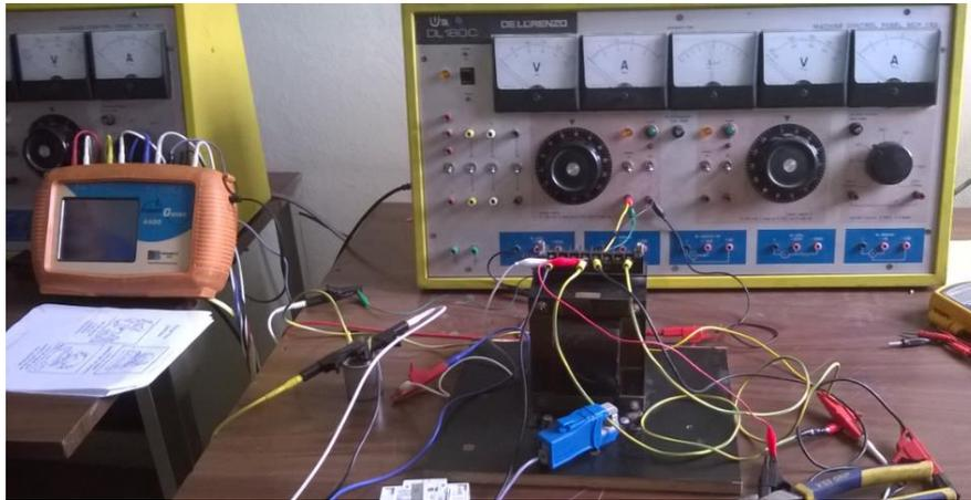
*Imagen 4.11 Conexión para realizar pruebas a circuito resonante monofásico.*
