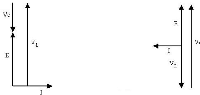
**Imagen 1.13** Diagramas fasoriales, en los puntos de operación de la componente fundamental del circuito LC serie no lineal, (a) Caso inductivo (puntos 1 y 2), (b) Caso capacitivo (punto3).
