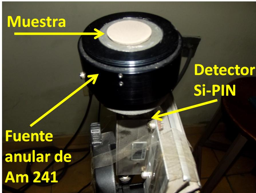
Figura 2.6: En esta foto se observa el detector y la fuente de excitación, ambos utilizados en el montaje experimental para la obtención de los espectros de FRX.
