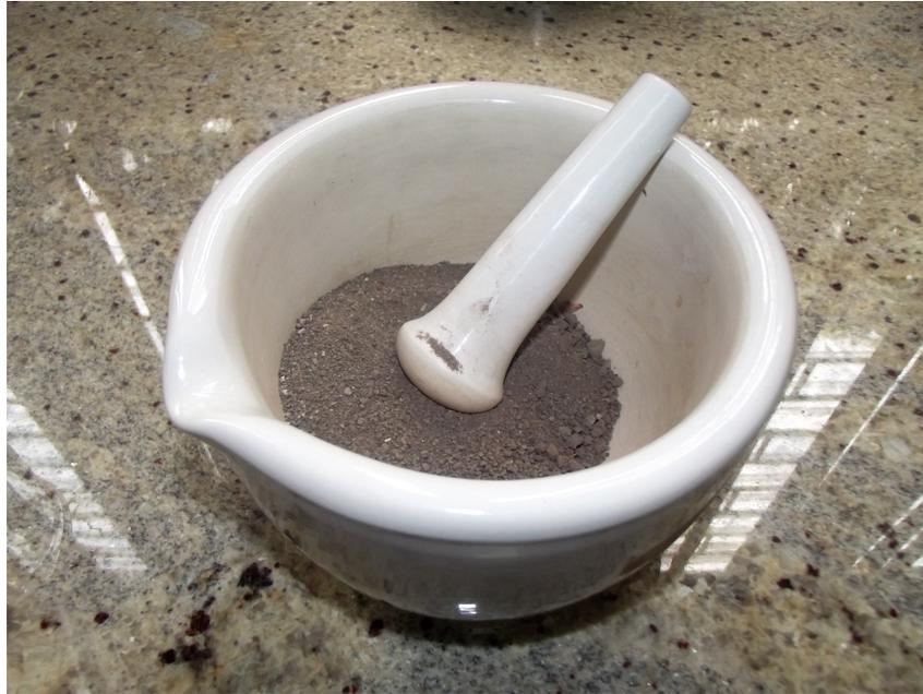
Figura 2.3: Mortero usado para moler las muestras de tierra.
