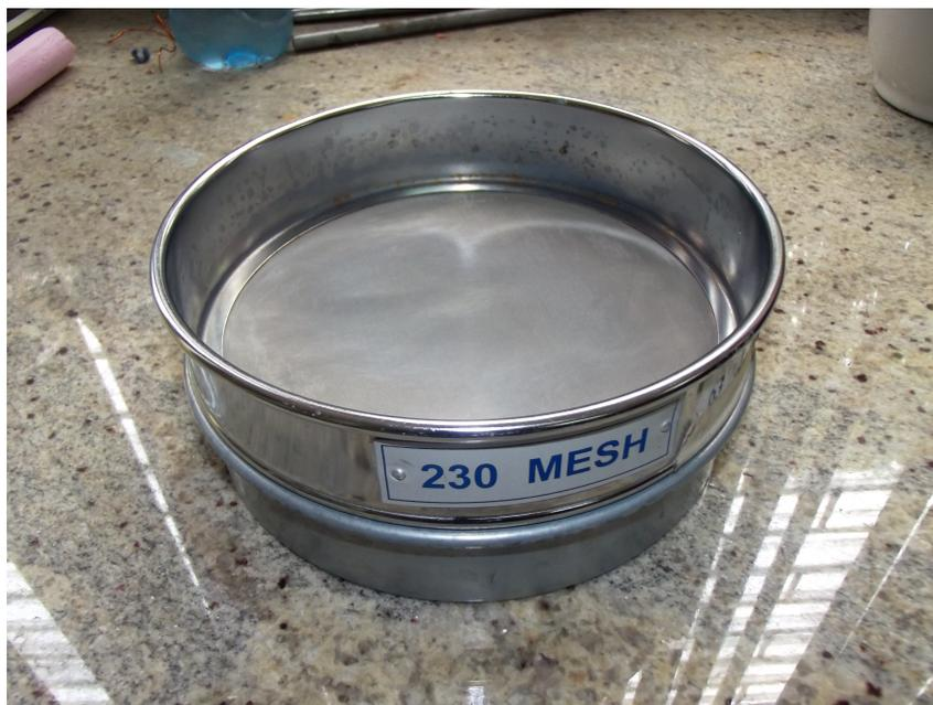
Figura 2.4: Tamiz usado para la creación de todas las pastillas.
