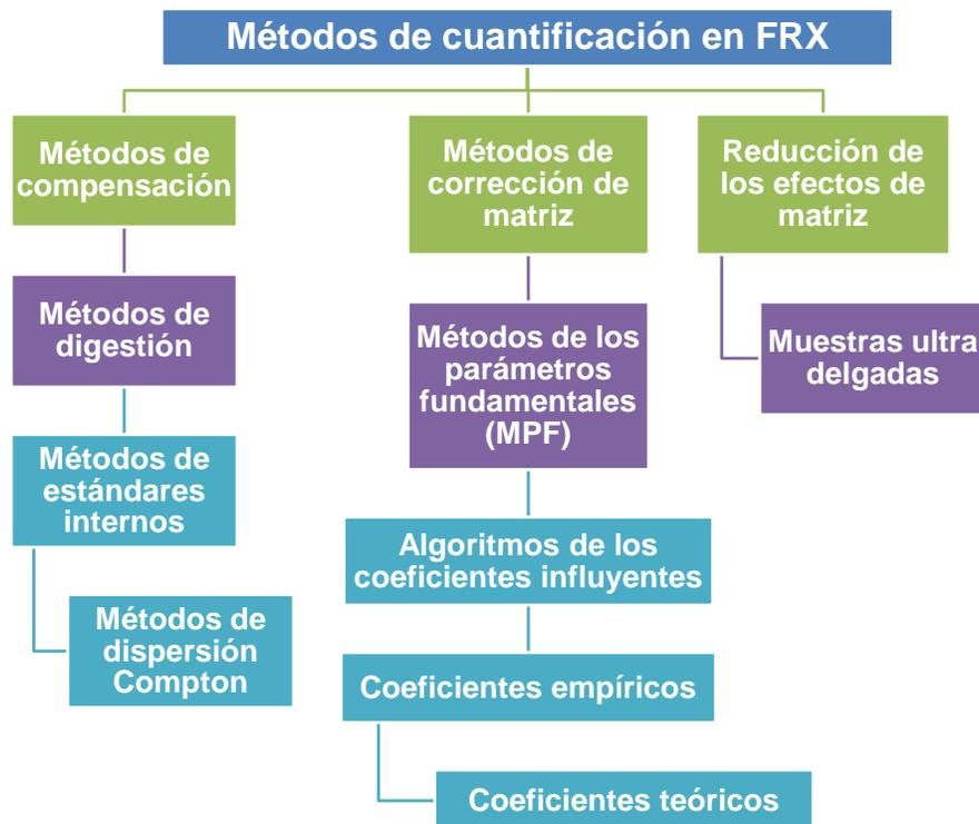
Figura 1.5: División general de los métodos aplicados a la cuantificación en los análisis de FRX [24].
