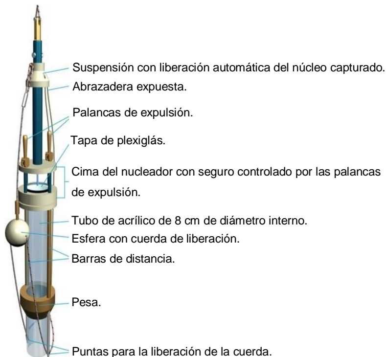
Figura 2.3. Nucleador de gravedad tipo Uwitec, utilizado para la extracción de los núcleos sedimentarios.
