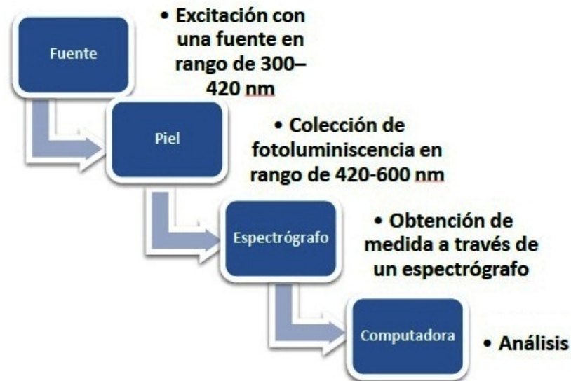
Figura 3.6: proceso para obtener medidas de fotoluminiscencia de AGE
