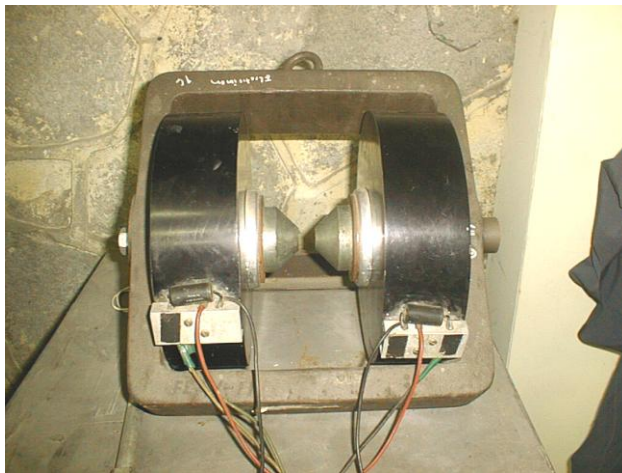
Figura 2.12: Electroimán utilizado para medir la magnetorresistencia en las muestras
