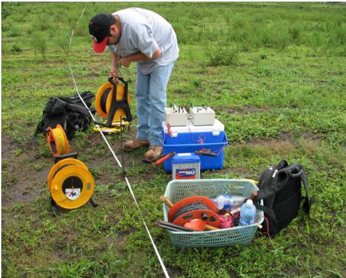
Figura 2.3 Muestra la realización del sondeo eléctrico vertical.
