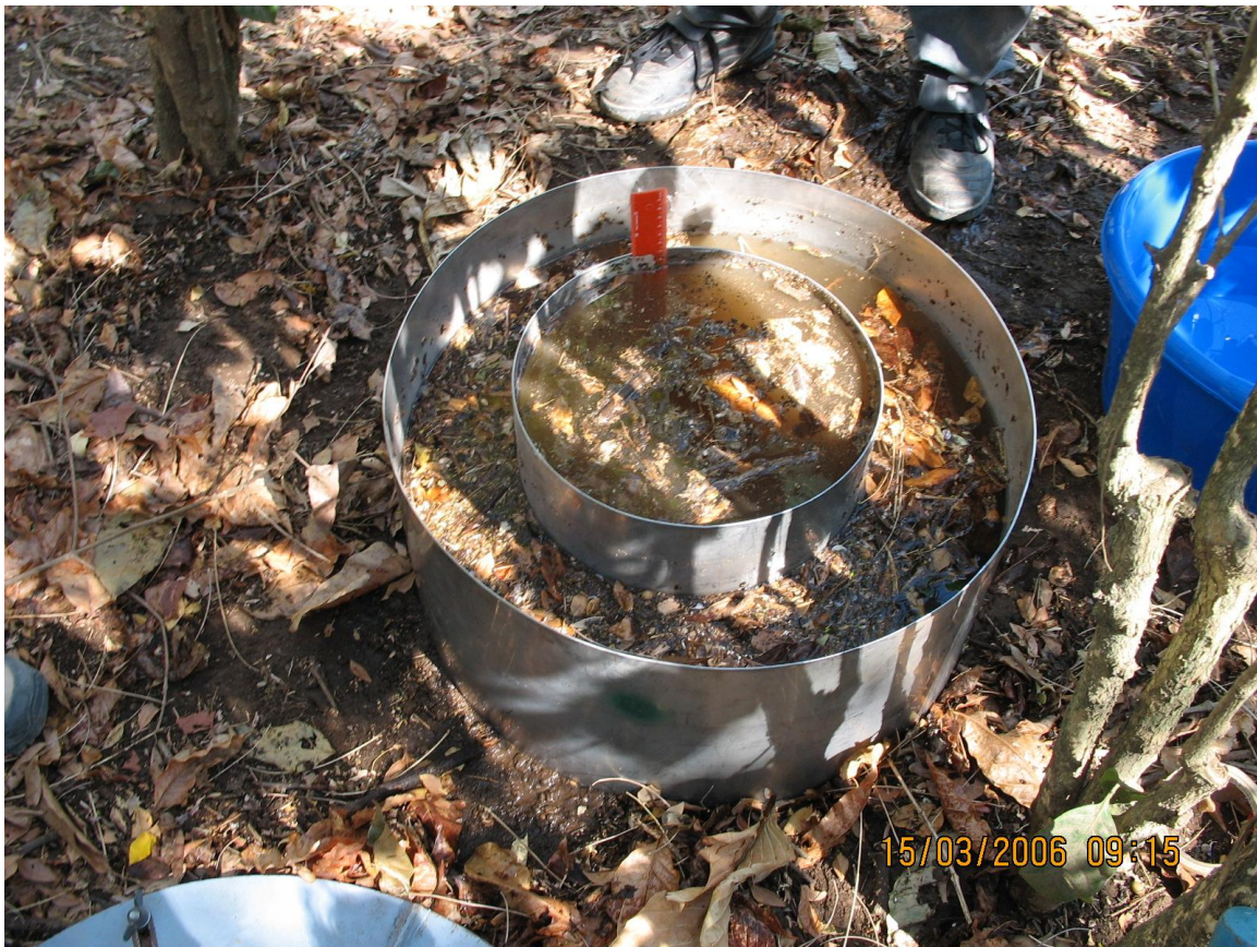
Figura 2.2 Muestra la aplicación de la prueba de infiltración.
