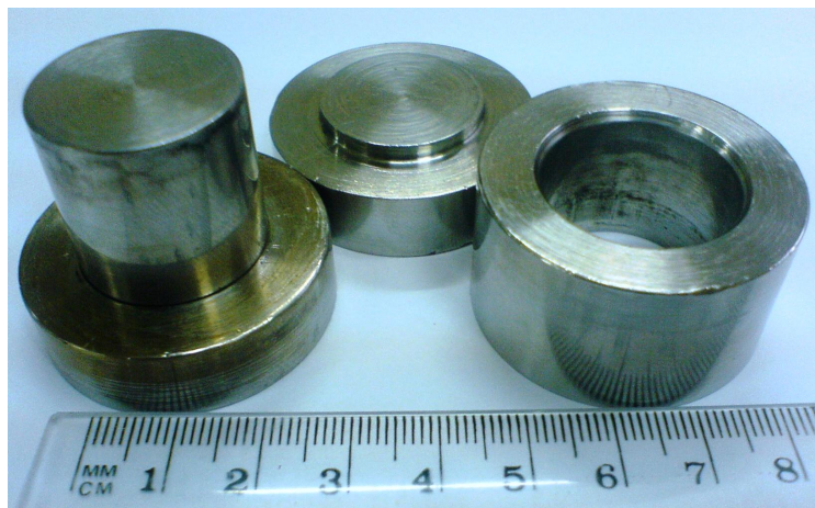
Figura 3.5: Piezas que conforman el molde para formar las pastillas. Ver valores de las dimensiones de cada pastillero en el anexo AI.
