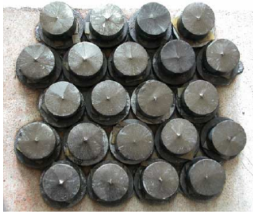
Figura 2.6: Discos superconductores de YBCO de 1.5 cm diámetro crecidos por MTG para utilizarlos en el sistemas de levitación magnética. Figura tomada de [51].
