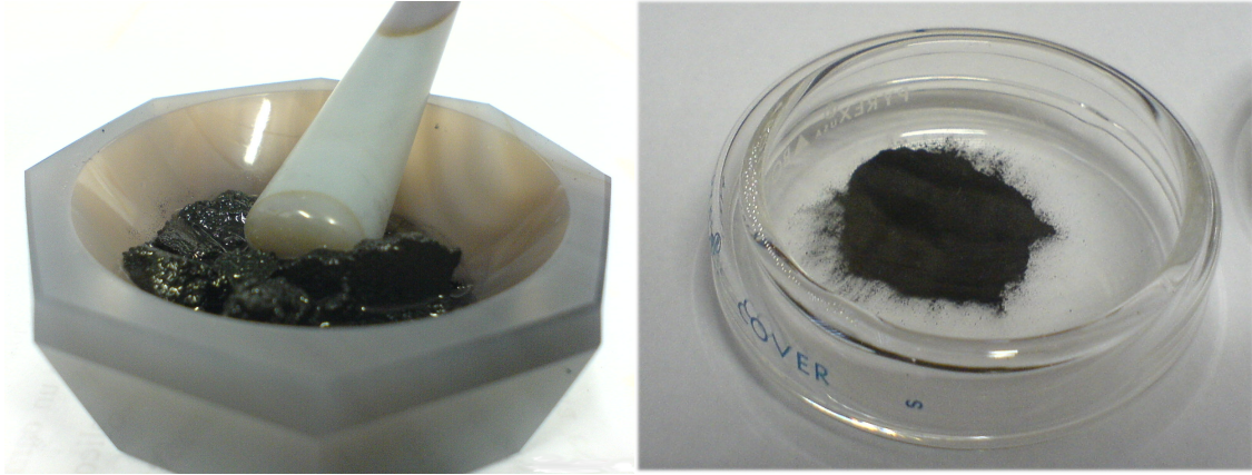
Figura 3.4: A la izquierda se muestra la mezcla, a temperatura ambiente, luego de salir de la mufa; lista para ser pulverizada con un poco de acetona calidad reactivo. A la derecha la mezcla superconductora ya pulverizada y colocada en su respectivo frasco petrie al final del proceso térmico intermedio; lista para iniciar el paso IV.
