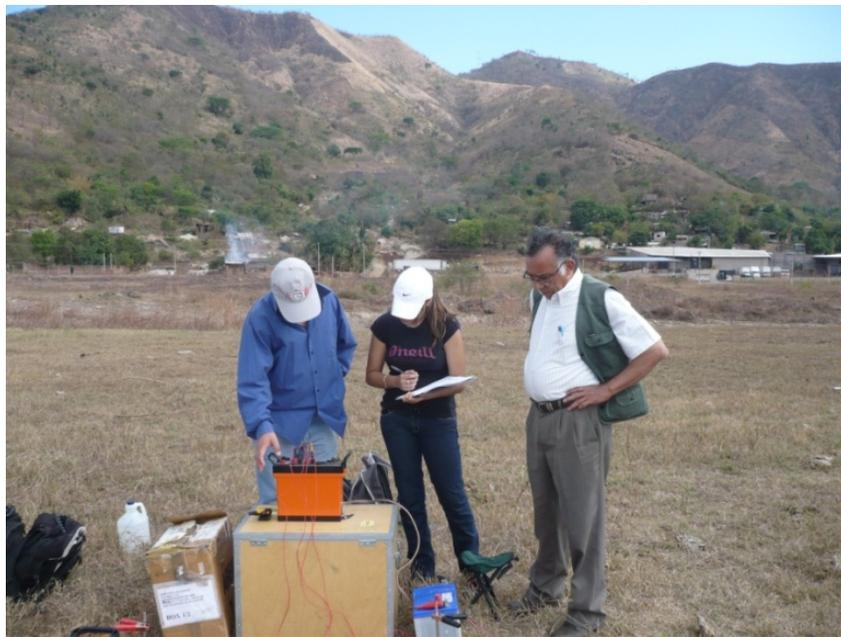
**Figura 4-6:** Fotografía muestra la realización de los Sondeos Eléctricos Verticales utilizando el método de Schlumberger una abertura de  $AB/2 = 250$  m en la zona de estudio
