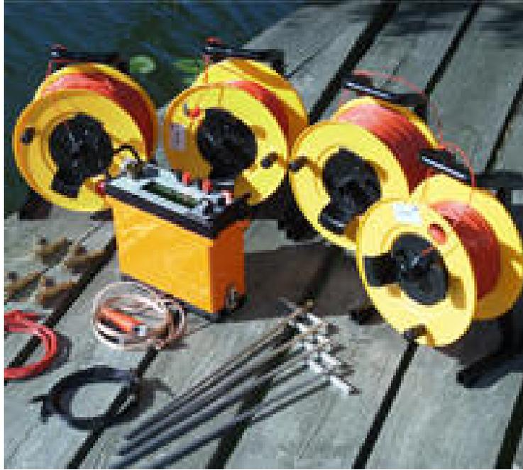
**Figura 2-6:** Foto del equipo de sondeo TERRAMETER SAS 4000;
