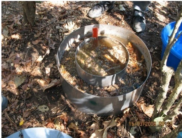
**Figura 3-1 : Cilindros Infiltrómetros (Doble Anillos)**
