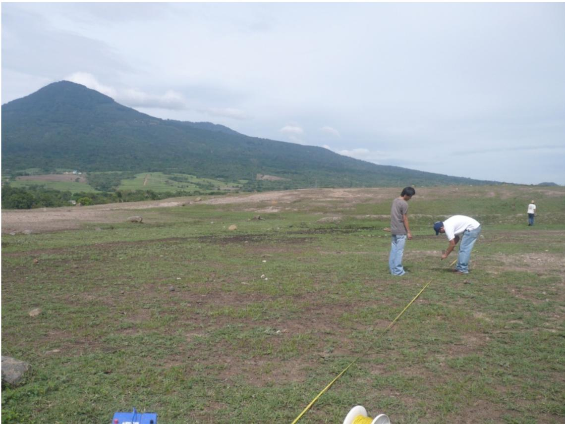
**Figura 4-7:** Fotografía muestra la realización de los perfiles eléctricos utilizando el método de Dipolo – Dipolo con  $a = 10$  m y  $n = 8$  en la zona de estudio
