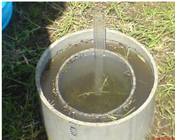
**Figura 4-5:** Muestra la realización de pruebas de infiltración aplicando el método de cilindros infiltrómetros en la zona de estudio
