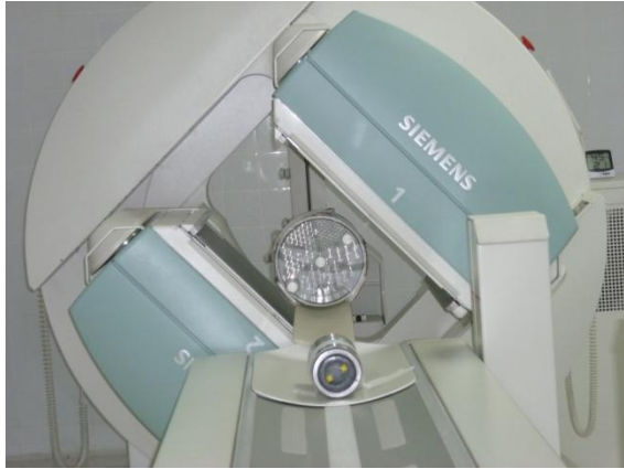
Figura 2.15.- En las imágenes se muestra el fantoma Jaszczkas en las gammacámaras Symbia y E.Cam para la evaluación del contraste de la imagen.
