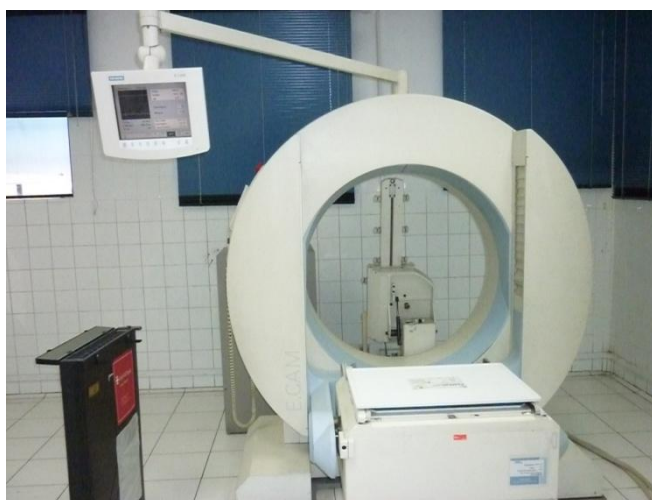
Figura 2.12.- Prueba de control de calidad para determinar resolución espacial extrínseca utilizando una fuente plana de ^{57}\text{Co} .
