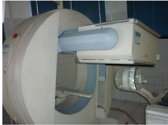
Figura 2.15.- En las imágenes se muestra el fantoma Jaszczkas en las gammacámaras Symbia y E.Cam para la evaluación del contraste de la imagen.
