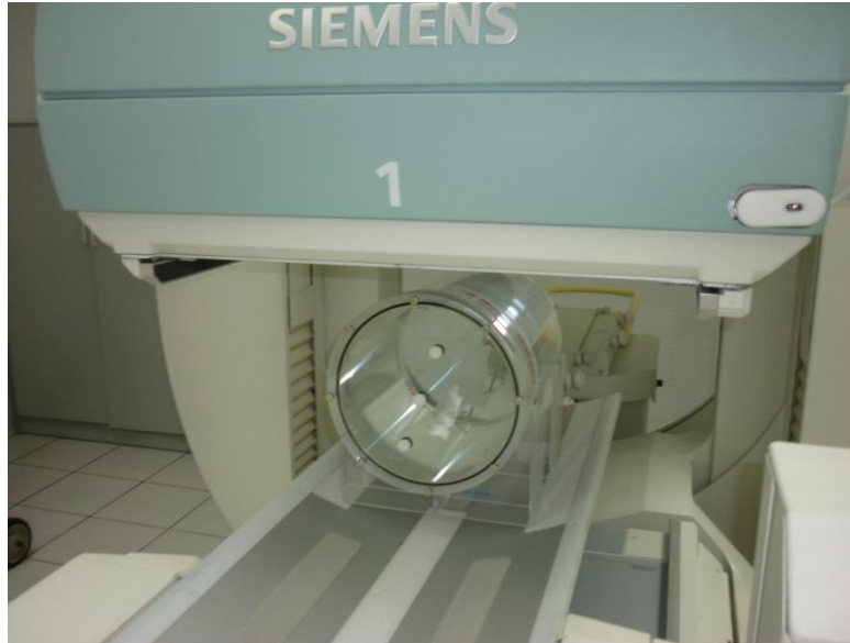
Figura 2.13.- Gammacámara E.Cam configurada para llevar a cabo la prueba de control de calidad de uniformidad tomográfica. En ella se puede observar el fantoma de uniformidad tomográfica.
