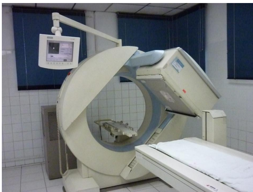
Figura 2.17.- Fuente puntual adherida al colimador en el detector de la gammacámara E.Cam, para medir la variación angular de la uniformidad y sensibilidad.
