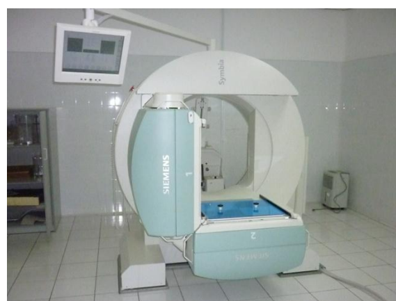
Figura 2.11.- Prueba de control de calidad para evaluar la resolución espacial intrínseca.
