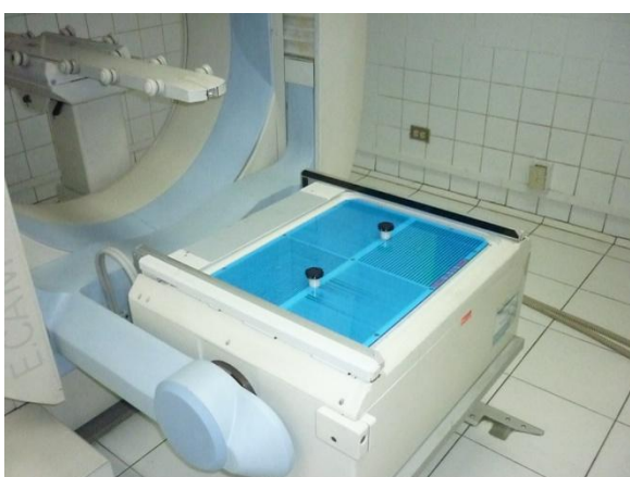
Figura 2.11.- Prueba de control de calidad para evaluar la resolución espacial intrínseca.
