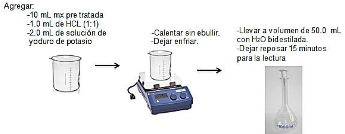
Figura N° 24. Esquema de preparación de la muestra de leche para la determinación de arsénico.
