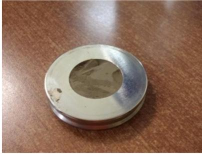
**Figura 16.** *Polvos compactados en porta muestra para el análisis de Difracción de Rayos X.*
