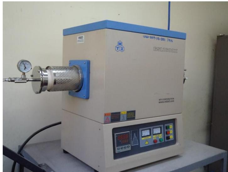
***Figura 40. Horno tubular MTI corporation modelo GSL 1600X; 25°C a 1600°C; utilizado para la sinterización de los materiales.***
