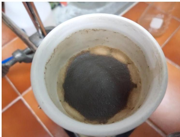
***Figura 38. Filtración por método Co-precipitación de hidróxido.***
