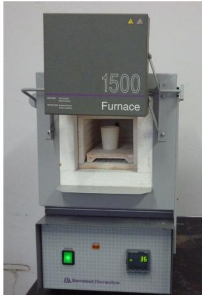
***Figura 39. Horno Barnstead international modelo FDI 1500M; 25°C a 1200°C, utilizado para la calcinación de los materiales.***
