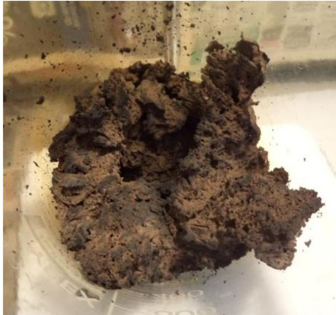
**Figura 10. a) Sistema para la obtención de la manganita de neodimio  $NdMnO_3$  por solución de complejos polimerizables. b) producto obtenido fenómeno puffing.**
