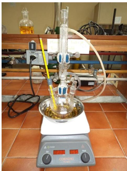
*Figura 11. Sistema para la obtención de la manganita de neodimio  $NdMnO_3$  por Co-precipitación.*
