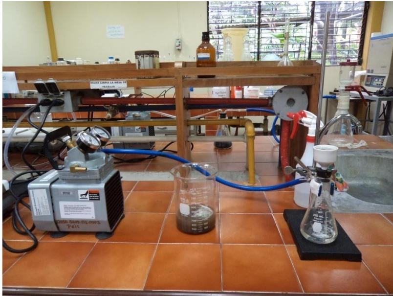
***Figura 37. Sistema de filtración método Co-precipitación de hidróxido.***
