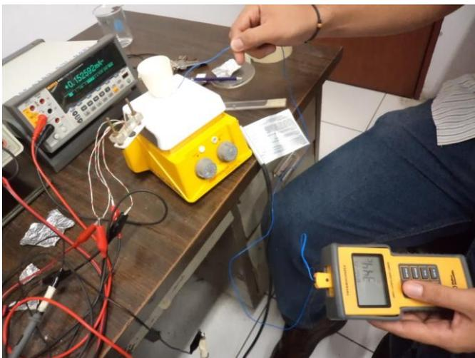
Caracterización eléctrica de las pastillas por el método de las cuatro puntas, usando diferentes temperaturas, ubicado en los laboratorios de la escuela de física de la Universidad de El Salvador.
