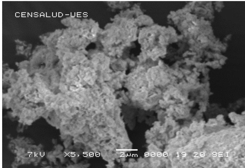
**Figura 28.** Micrografía obtenida por MEB, de polvos de GDC preparados por el método de solución de complejos polimerizables, calcinados a 700°C durante dos horas.
