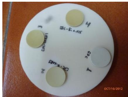
**Figura 32.** Muestras de GDC, GDC-Bi<sub>0.005</sub>, GDC-Bi<sub>0.01</sub>, GDC-Bi<sub>0.015</sub> compactadas, antes de la sinterización.
