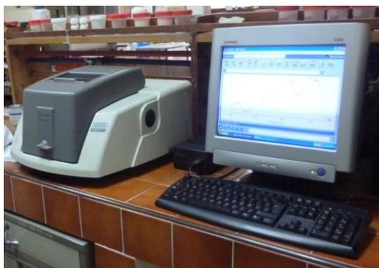
**Figura 18.** Espectrómetro infrarrojo Avatar 330 FT-IR, Thermo Nicolette
