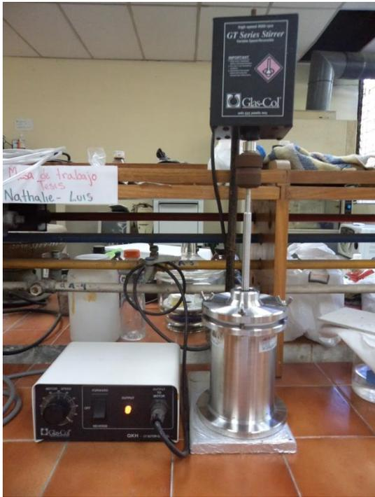
Molino de atrición, usado para la molienda de los polvos calcinados.
