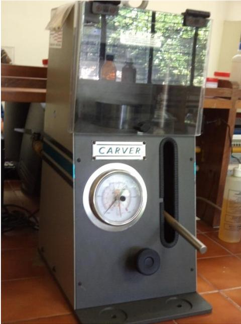
Prensa uniaxial usada para el prensado de las muestras en verde.
