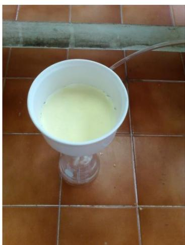
Filtración de muestra obtenida por coprecipitación
