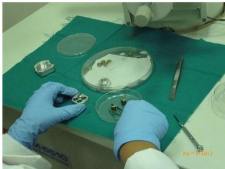
Anexo 14. Preparación de las muestras para microscopia electrónica de barrido
