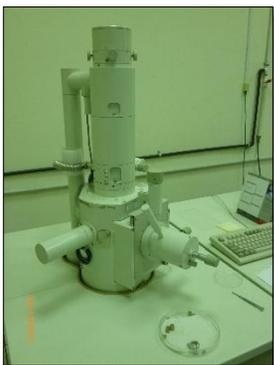
Para determinar la morfología del cermet a obtener fue necesario conocer el tamaño de grano y el tipo de aglomerados, es por ello que se aplicó este método de análisis; el cual consiste en recubrir las muestras con una capa de oro y posteriormente se realizó la lectura en el microscopio. Obteniendo diferentes micrografías de las muestras.
