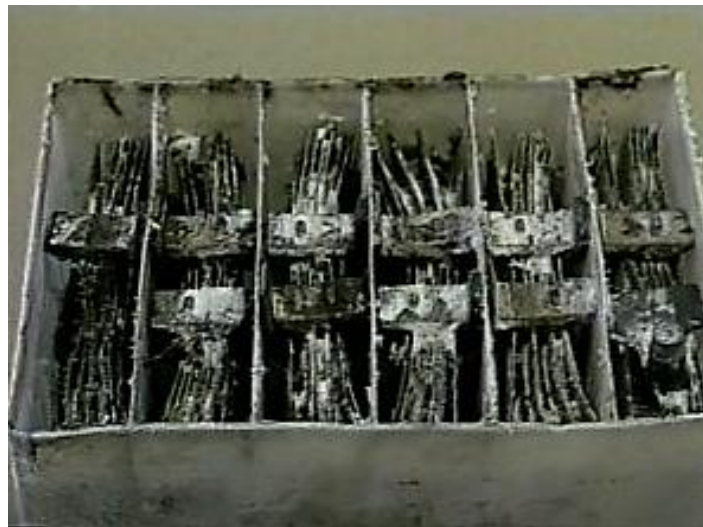
Figura 23: Batería con un proceso de sulfatación grave, donde se pueden apreciar sus celdas dañadas. [11]
