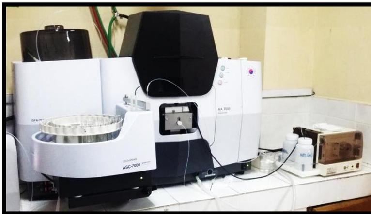
Figura 2. 14 Equipo completo (absorción atómica por llama con sistema generador de hidruros).
