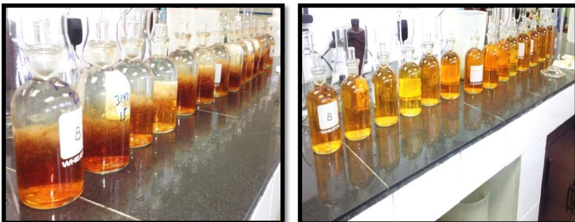
Figura 2. 6 Muestras después de adición de ácido sulfúrico y agitación.
