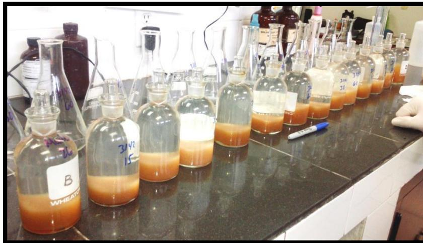
Figura 2. 5 Muestras después de adición de reactivos sulfato manganoso y álcali-yoduro-nitruro.
