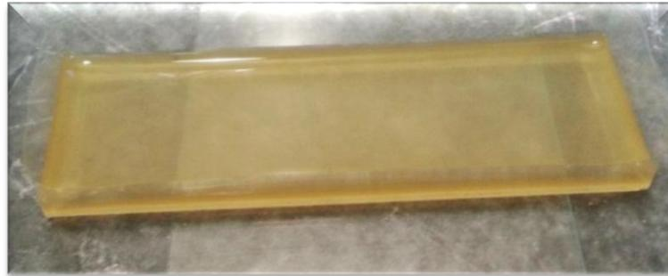
**Figura 21.** Membrana de acetato de celulosa recién depositada en el soporte.
