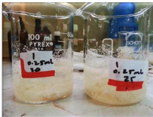
**Figura 17.** Proceso de hidrólisis parcial del triacetato de celulosa (en forma de copos).
