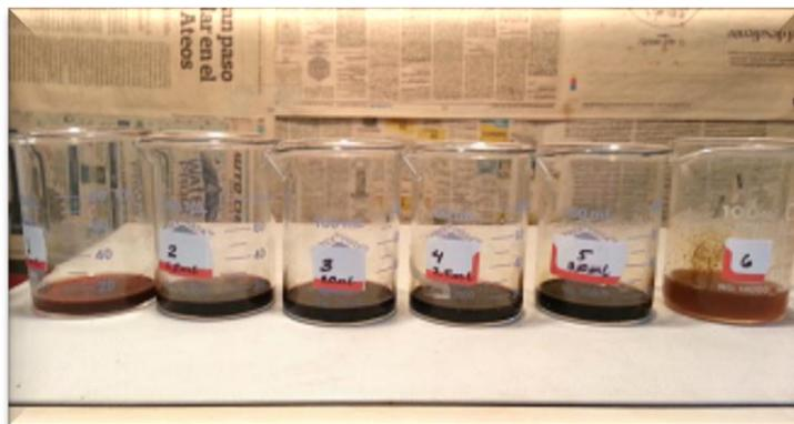
**Figura 15.** Proceso de esterificación de la celulosa, con anhídrido acético utilizando como catalizador el Ácido Sulfúrico
