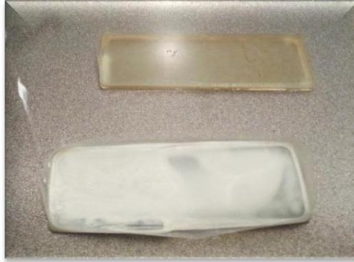
**Imagen 22.** Membranas las cuales fueron rechazadas debido a imperfecciones en el proceso de coagulación, (baño de agua a 23°C)
