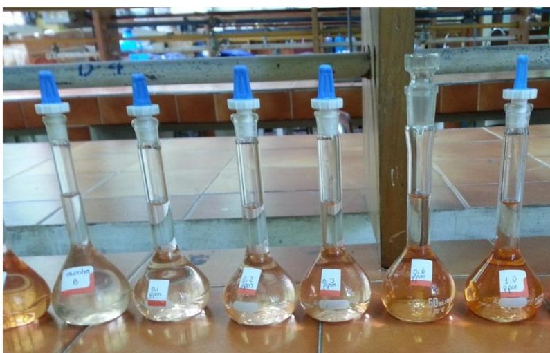
**Figura 24.** Soluciones para la curva de calibración de Fe.
