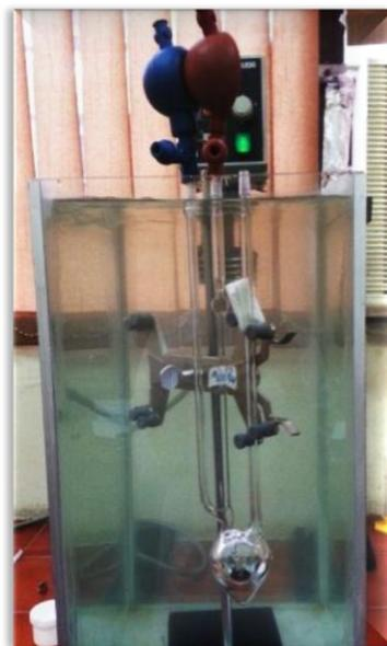
**Figura 20.** Viscosímetro de Ubbelohde
