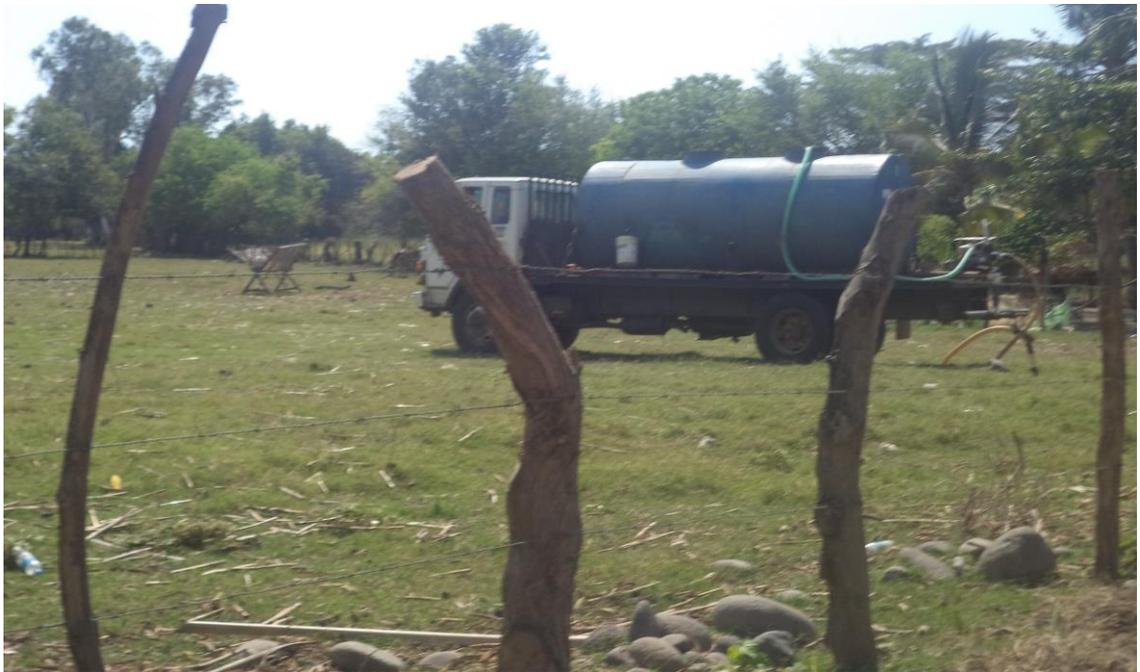
**Fotografía 4:** Extracción de agua subterránea a través de un pozo de punta hacia una pipa en la colonia ISTA.
