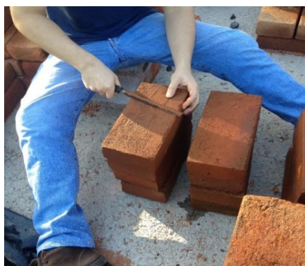
Fig. 3.4 – Preparación de las caras de las unidades superiores e inferiores de los prismas.
