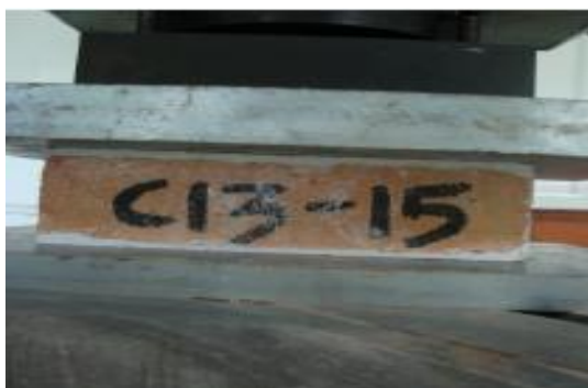
Fig. 2.9 – Ensayo a compresión de unidades de ladrillo de barro cocido.
