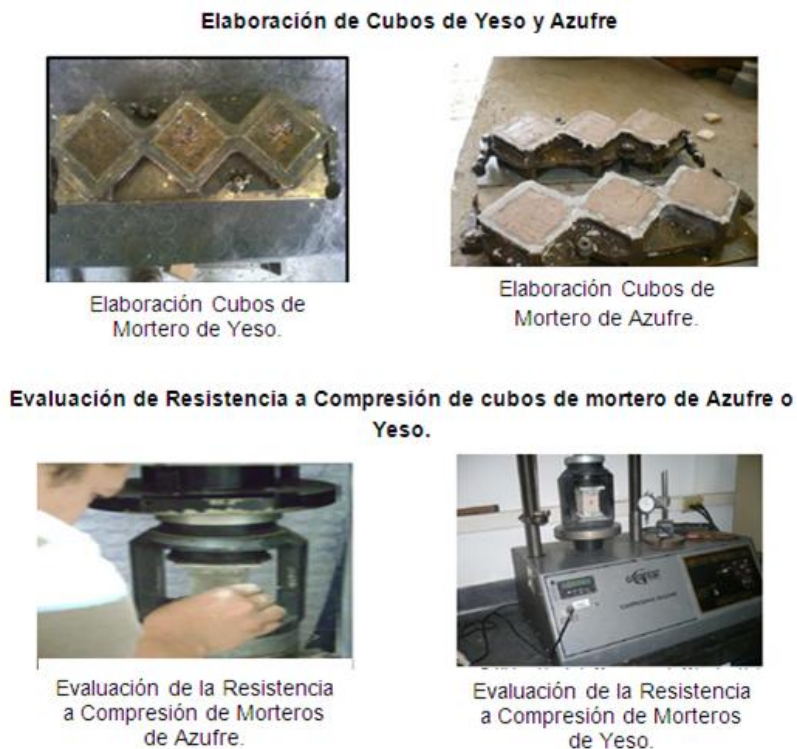
Fig. 2.5 – Proceso de elaboración de cubos de mortero de yeso y azufre.
