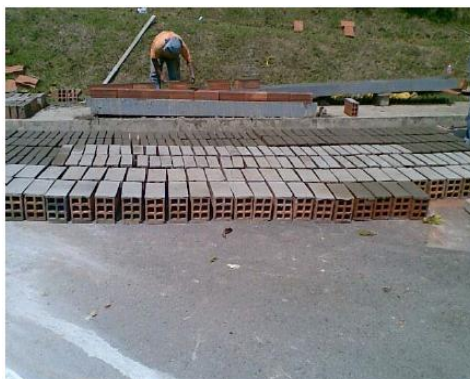
Fig. 2.3 – Unidades huecas de ladrillo de barro cocido.
