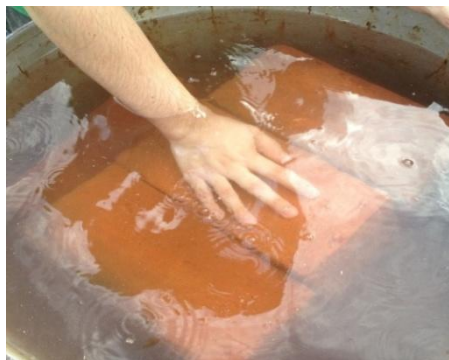
Fig. 3.6 – Proceso de saturación de las unidades.
