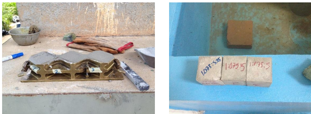
Fig. 3.1 – Cubos de mortero obtenidos de la mezcla; Identificación de los cubos para su proceso de curado.
