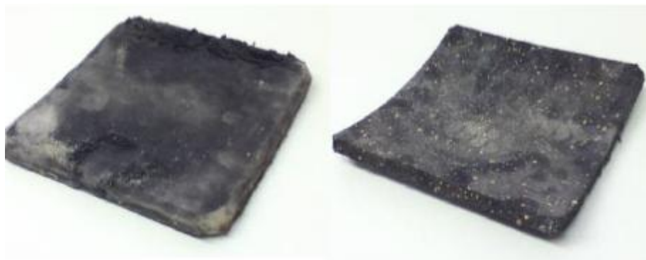
Fig. 2.8 – Neopreno (a la izquierda) y caucho reciclado (a la derecha).
