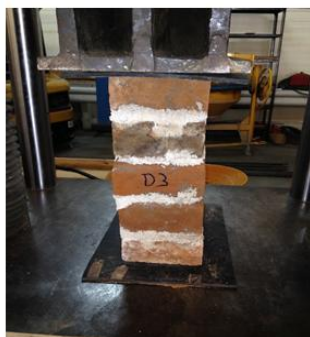
Fig. 3.20 – Uso de refrentado no adherido durante el ensayo.
