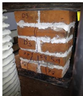
Fig. 3.20 – Uso de refrentado no adherido durante el ensayo.
