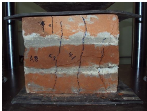
Fig. 4.3 – Falla del tipo frágil.
