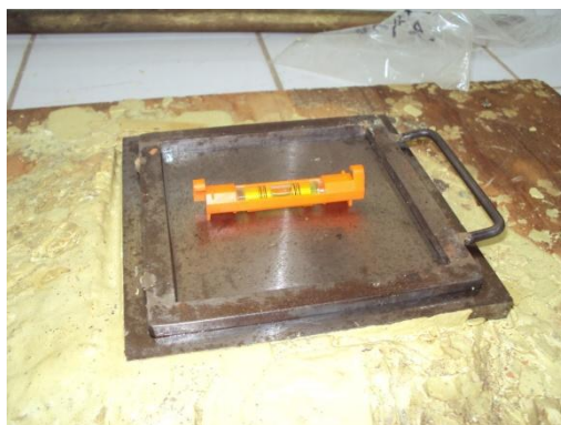
Fig. 3.15 – Preparación y limpieza de la placa de refrentado.
