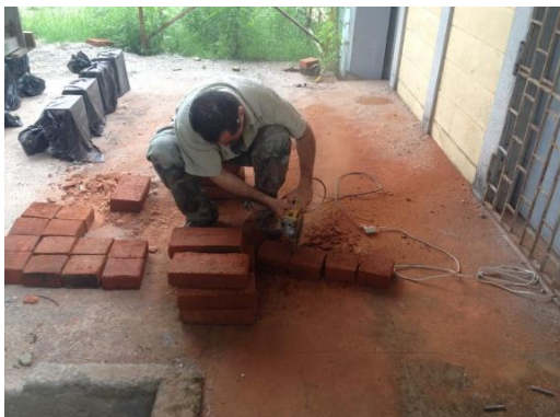
Fig. 3.5 – Corte de las unidades para prismas con junta vertical.
