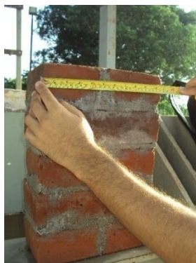
Fig. 3.19 – Toma de medidas del prisma.
