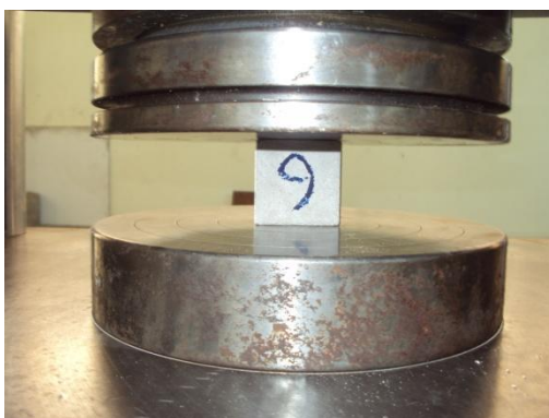
Fig. 3.18 – Ensayo a compresión de cubos de mortero.
