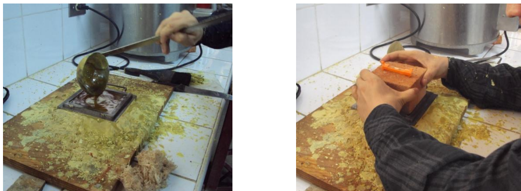
Fig. 3.16 – Proceso de refrentado de los especímenes.
