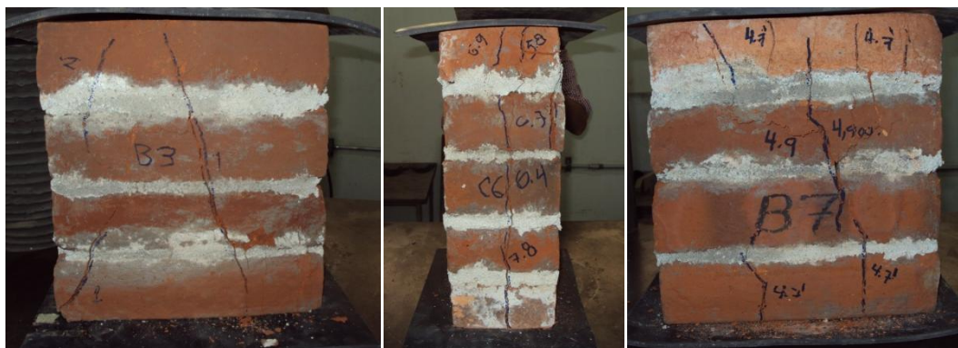
Fig. 4.2 – Tipos de falla presentes. De izquierda a derecha: Falla por tracción diagonal, separación de la unidad y agrietamiento de la unidad extrema.
