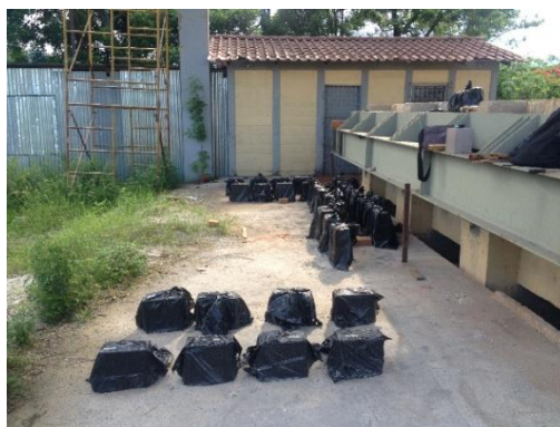
Fig. 3.10 Curado sellado de prismas.
