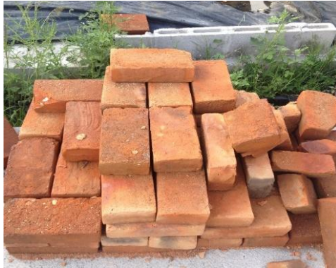
Fig. 2.2 – Unidades de ladrillo de barro cocido sólidas.
