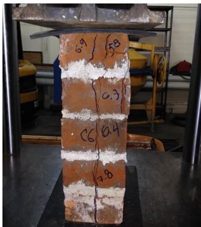
Fig. 2.11 – Ensayo de prismas de mampostería de ladrillo de barro cocido.
