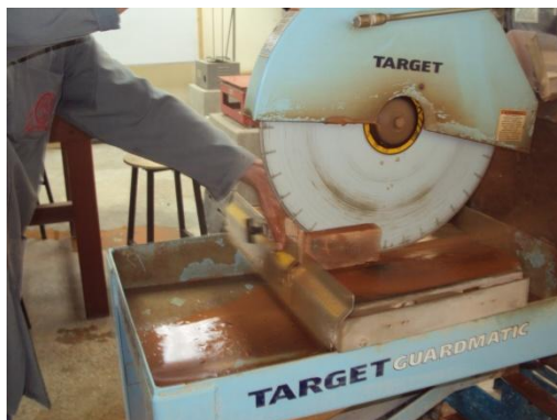
Fig. 3.12 – Corte con disco de las unidades.
