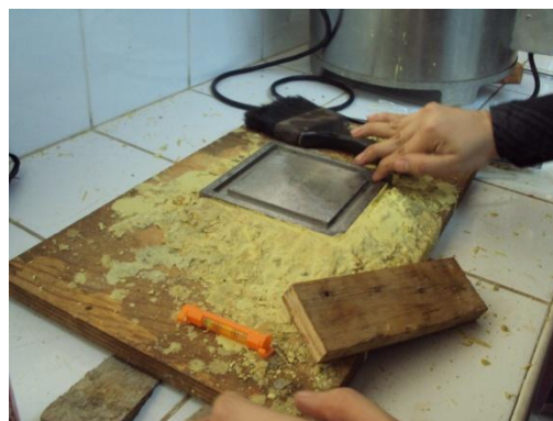
Fig. 3.15 – Preparación y limpieza de la placa de refrentado.
