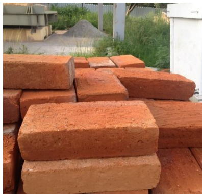
Fig. 3.3 – Unidades utilizadas en la construcción de prismas
