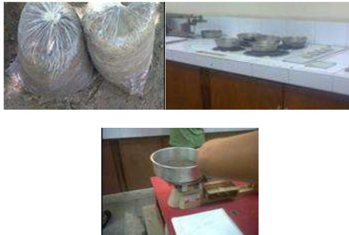
Figura 4. 7- Determinación de contenidos de humedad bajo norma ASTM D4959
