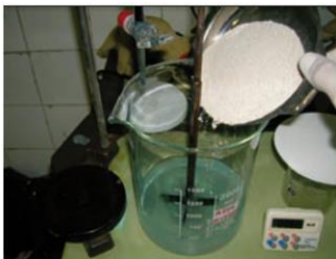
Fig. B.7. Procedimiento para la obtención de la lechada.
