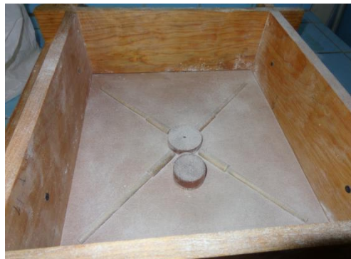
Fig. 4.17. Forma correcta de expansir talco sobre el modelo.
