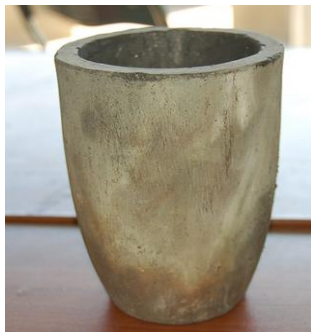
Fig. 1.3. Crisol normal de grafito con cierta cantidad de arcilla.
