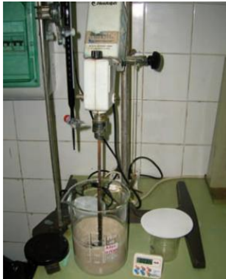
Fig. 3.8. Mezcla del agua destilada con la arena de muestra.
