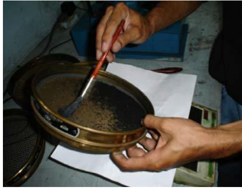
Fig. 3.4. Limpieza de los tamices.
