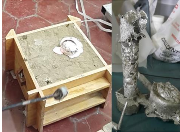
Fig. 4.14. Efectos del exceso de humedad a las piezas fundidas.
