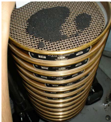
Fig. B.2. Colocación de la arena en los tamices.
