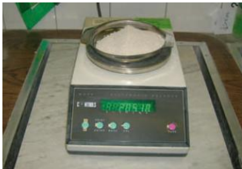
Fig. 3.5. Balanza de precisión donde se pesa la muestra de arena.
