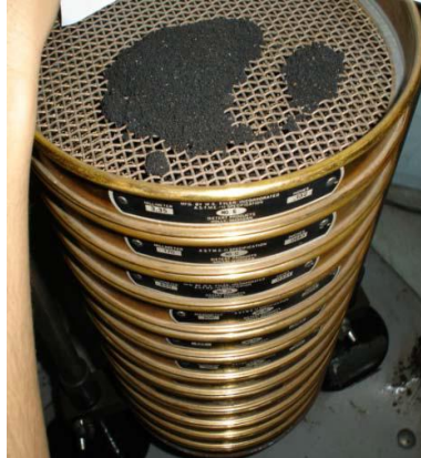
Fig. 3.2. Colocación de la arena en los tamices.
