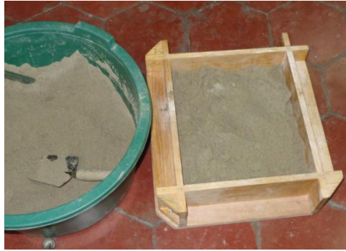
Fig. 4.18. Llenado de la caja de moldeo con arena.
