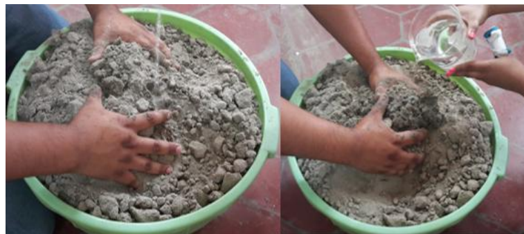
Fig. 4.13. Forma adecuada de mezclar la arena con su humedad correspondiente.
