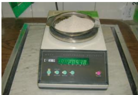
Fig. B.5. Balanza de precisión donde se pesa la muestra de arena.
