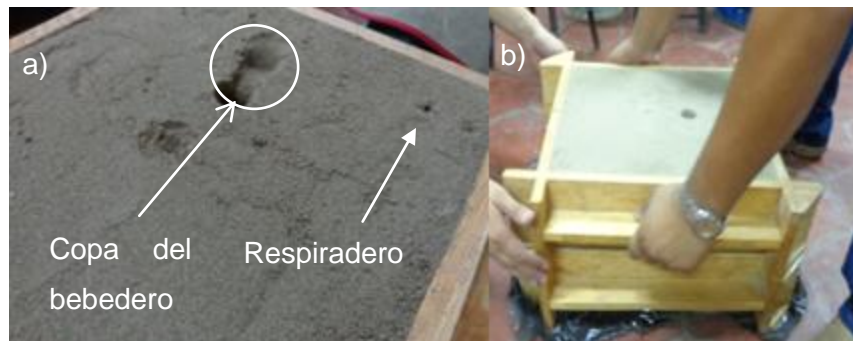
Fig. 4.23. Detalles finales del molde: a) copa del bebedero y respiraderos señalados y b) unión de los 2 moldes.
