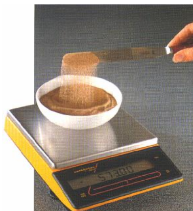
Fig. 3.14. Peso de la muestra húmeda junto con su recipiente.
