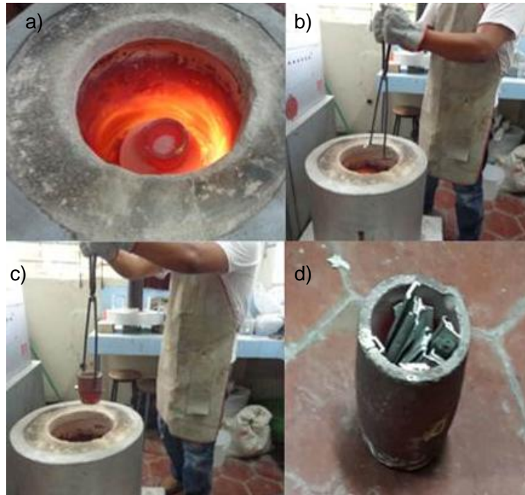
Fig. 4.25. Proceso de llenado del crisol.
