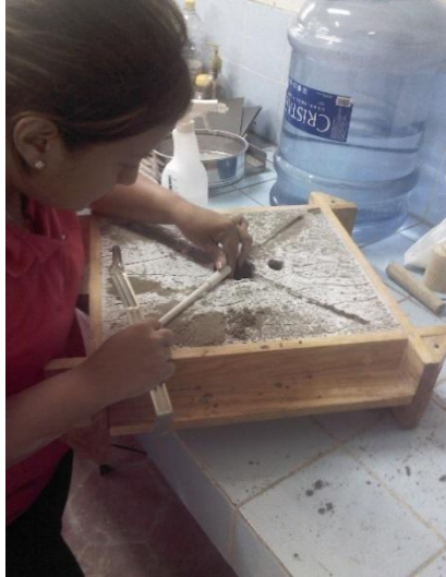
Fig. 4.22. Acabados realizados al molde antes de unir ambas partes de la caja de moldeo.
