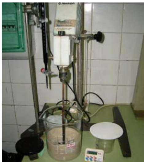
Fig. B.8. Mezcla del agua destilada con la arena de muestra.
