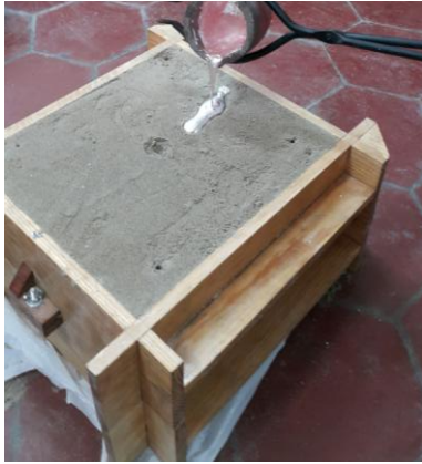
Fig. 4.28. Colada del aluminio sobre la copa de vaciado.
