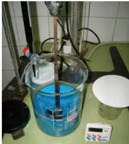
Fig. 3.9. Mezcla de la solución de azul de metileno con la lechada.
