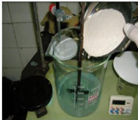
Fig. 3.7. Procedimiento para la obtención de la lechada.
