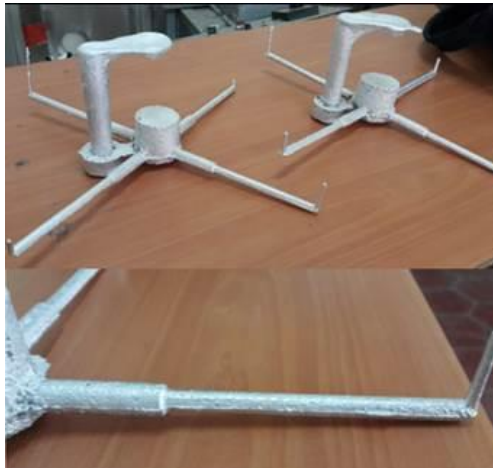
Fig. 4.30. Piezas obtenidas en las fundiciones.
