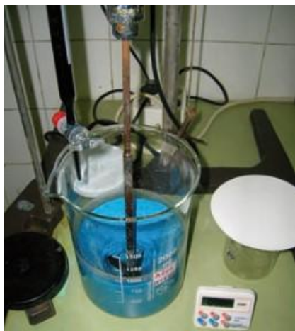
Fig. B.9. Mezcla de la solución de azul de metileno con la lechada.
