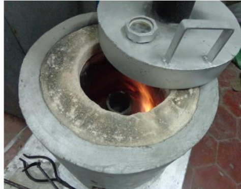
Fig. 4.24. Precalentamiento del crisol.
