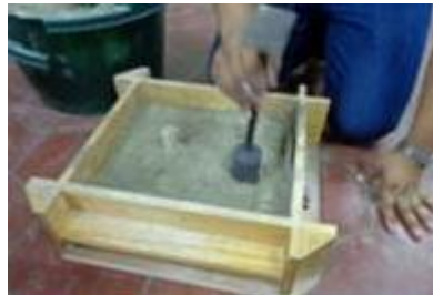
Fig. 4.19. Compactando la arena de moldeo.
