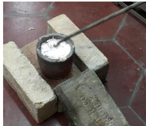
Fig. 4.27. Procedimiento antes de la colada con el aluminio, colocación del desgasificador.
