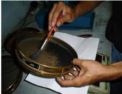
Fig. B.4. Limpieza de los tamices.
