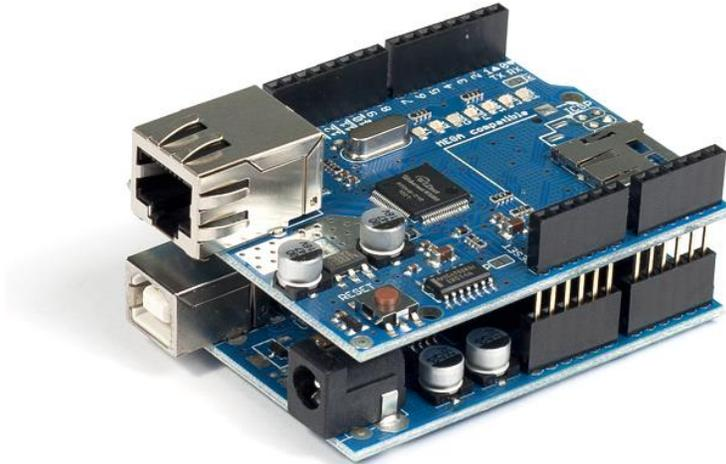
Figura 49: Arduino y modulo Ethernet.
