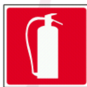
Figura No. 12. Señal de Equipos contra Incendios
