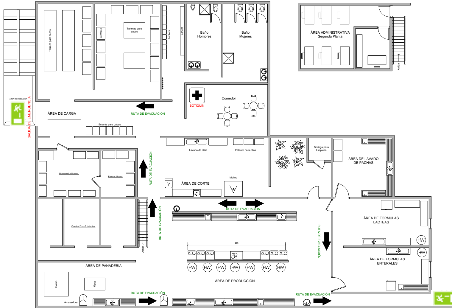
Figura No. 15. Señalización de Emergencia del Departamento de Alimentación y Dietas
