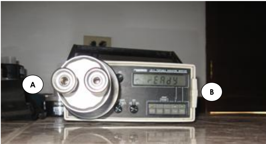
Figura 7. Diagrama del equipo utilizado para la medición de radón y torón: A. Celda de Lucas modelo Pylon 300 a y B. Monitor de Radiación Portable modelo Pylon AB-5.
