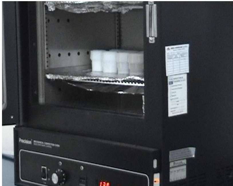
Figura 12. Estufa para secado de muestras de sedimento y tejido blando de Anadara spp.
