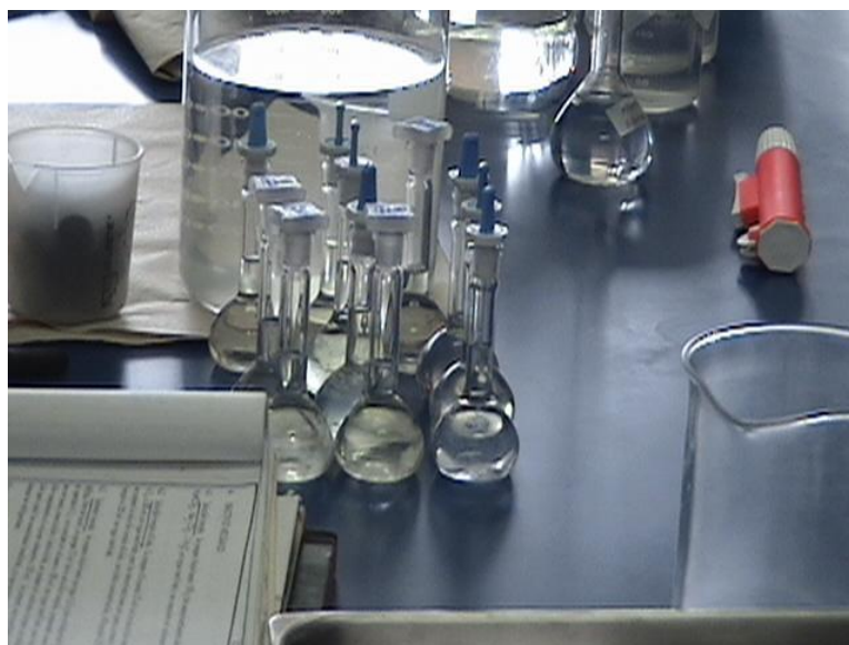
Figura 14. Balones conteniendo sustancias digeridas de sedimento y Anadara spp. listas para leer en espectrofotómetro de absorción de masa.
