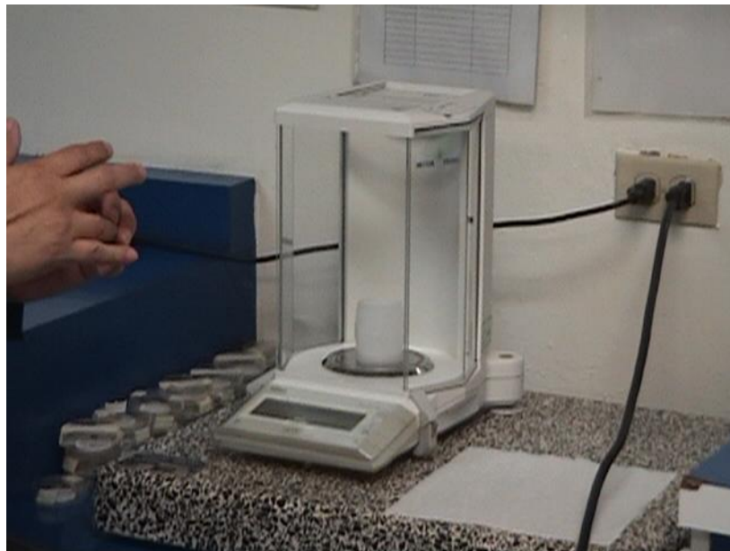
Figura 11. Balanza analítica para medir la cantidad de muestra y reactivos necesarios para el proceso analítico.
