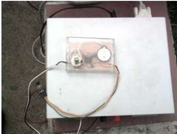
Fig IV.7 Sensor de temperatura instalado en la estación MOV02.
