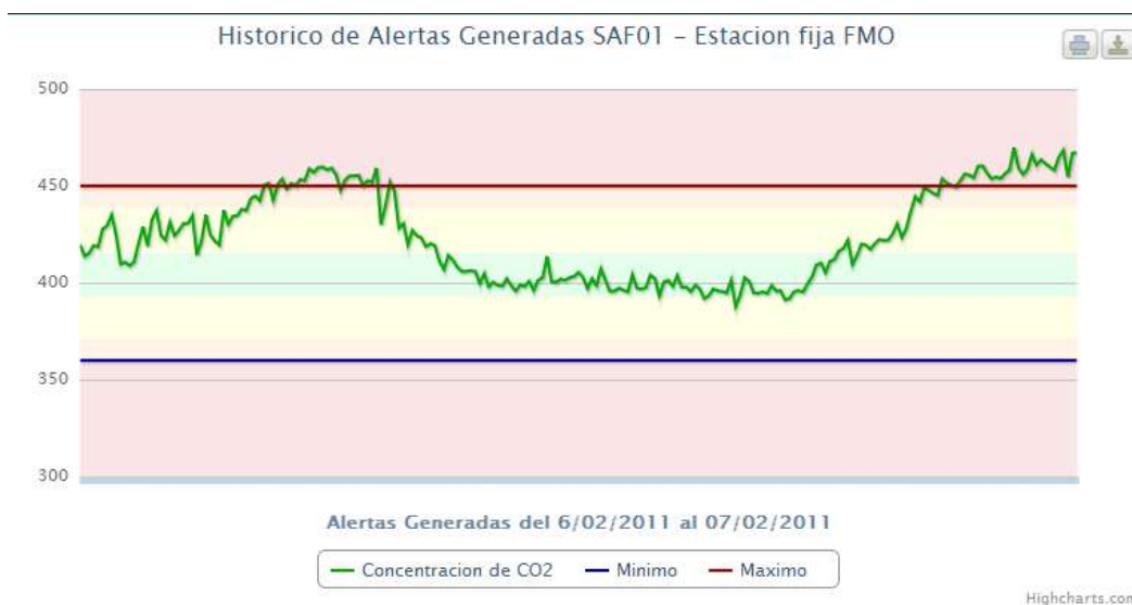
Fig IV.6 Informe de alertas generadas en la estación SAF01.
