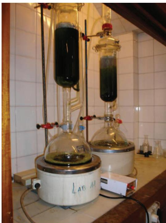
**Fig. 23** Aparato de extracción continua Soxhlet
