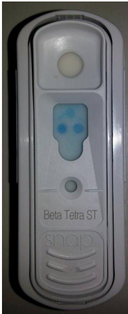
Figura N° 21 Lectura de resultados por medio del Kit rápido SnapDuo Tetra-Beta ST
