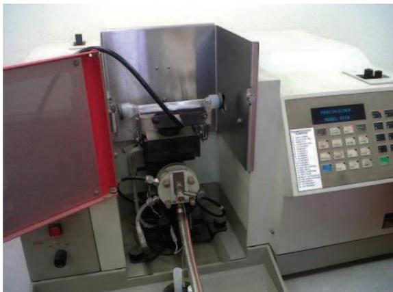
**Equipo:** Espectrómetro de Absorción Atómica de doble haz, Marca Perkin Elmer, Modelo 3110.
