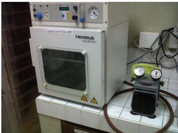
Equipo: Horno con sistema de vacío
