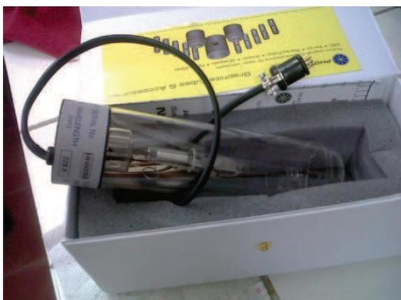
**Fuente:** Lámpara de cátodo hueco para determinación de Cd con longitud de onda de trabajo de 228.8 nm.
