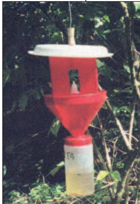
ANEXO 16. Trampa con techo a 0 cm de altura, con respecto a la altura de las aspas.
