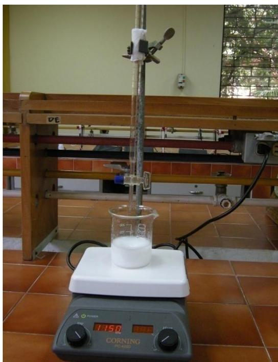
Figura 6: Sistema de adición del fosfato diácido de amonio.
