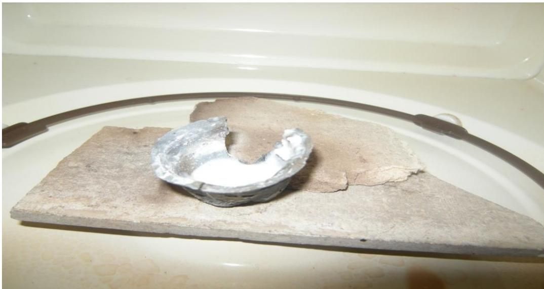
Figura 12: Crisol de carburo de silicio en el que se calentó las muestras en el microondas.
