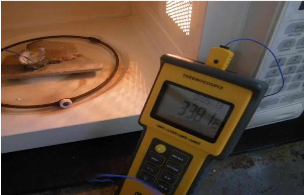
Figura 11: Termocupla utilizada para medir la temperatura cuando se calentó por microondas las muestras.
