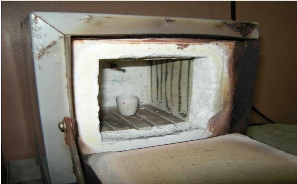
Figura 9: Mufla utilizada para el calentamiento clásico
