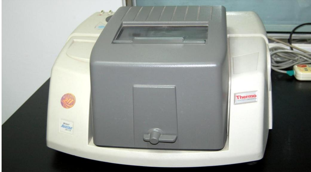
**Figura 1: Infrarrojo con transformada de furrier
