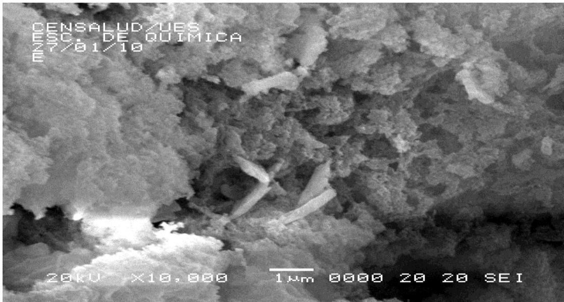
**Figura 20: Micrografía de la Hidroxiapatita, obtenida por precipitación sin tratamiento de calor.**
