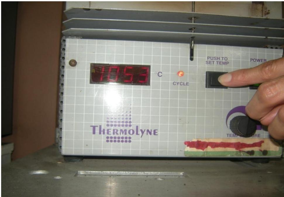
Figura 10: sistema que muestra el control digital para calentar la mufla
